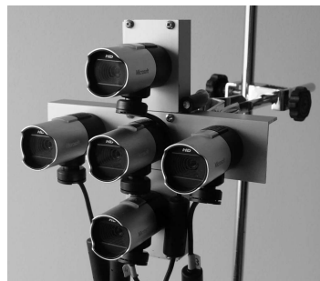
Rys. 1. Układ kamer o nazwie EBMCS (Equal Baseline Multiple Camera Set) użyty w eksperymentach
