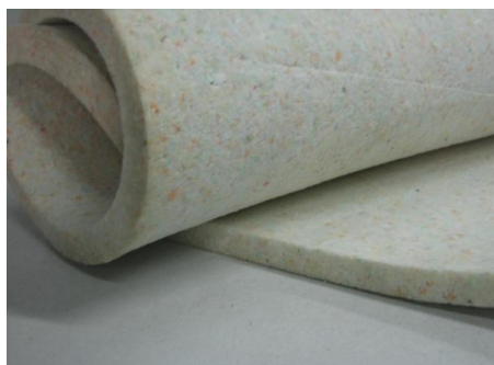
Rysunek 6.8 Pianka poliuretanowa wtórnie spieniona.
