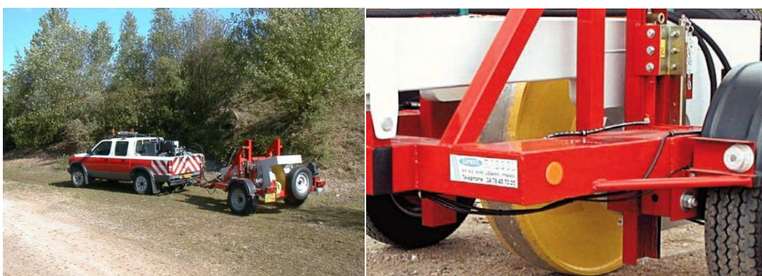
Rysunek 3.9 Sprzęt do badań portancemetrem (VECTRA France, 2016)
