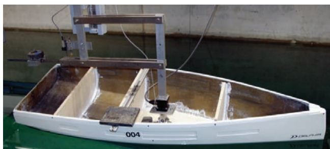
Rys. 9. Model podwieszony na wózku holowniczym
