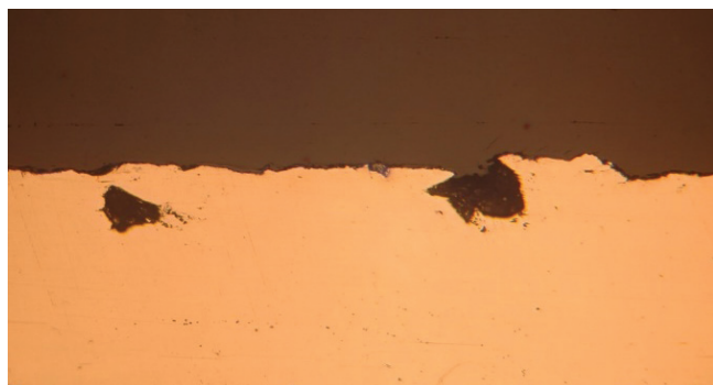
Rys. 6. Zgląd metalograficzny nietrawiony (rejon – odcinek prosty rury). Powiększenie 1000×. Widoczne uszkodzenie materiału w postaci dwóch wyraźnych ognisk korozyjnych
