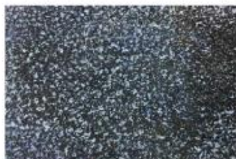
FOT. 12. Widok struktury porów tynku gipsowo-wapiennego; fot.: autorzy
