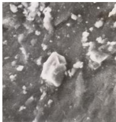
Rys. 8. Mikrofotogram powierzchni żeliwa EN-GJS-600-3 po docieraniu ( p = 0,0075 MPa, v = 0,73 m/s, t = 240 s); mikroskop JSM-S1, powiększenie robocze 10 000 razy
