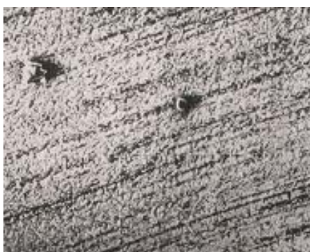
Rys. 12. Przykłady skażenia powierzchni stali NC6 po docieraniu i niedostatecznym myciu pooperacyjnym
