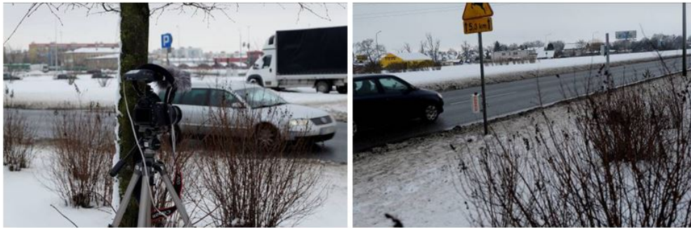
Rysunek 5.3: Akwizycja danych pomiarowych, rejestrator z kamerą wideo (po lewej) oraz radarowy rejestrator ruchu dzięki uprzejmości GDDKiA (po prawej)
