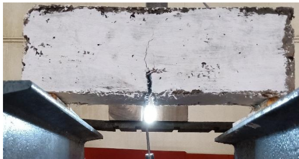
Fig. 4 Mode-I fracture test setup
