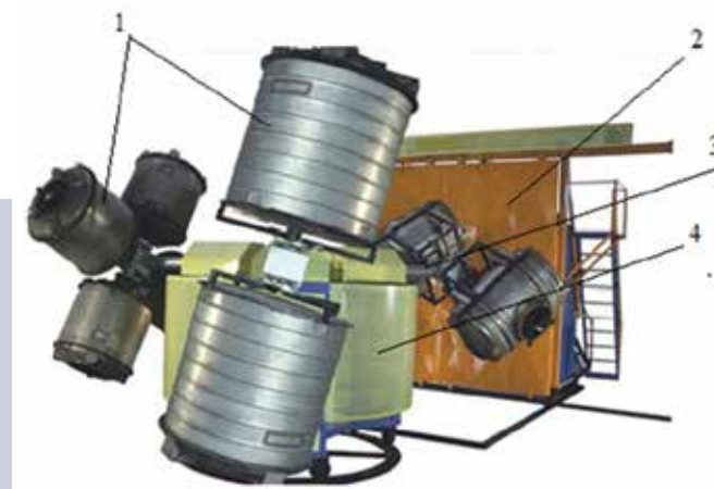
Rys. 3. Maszyna do odlewania rotacyjnego typu karuzelowego trójramienna: 1 - formy odlewnicze, 2 - układ grzewczy, 3 - ramię mimośrodkowe, 4 - układ chłodzenia [1]
