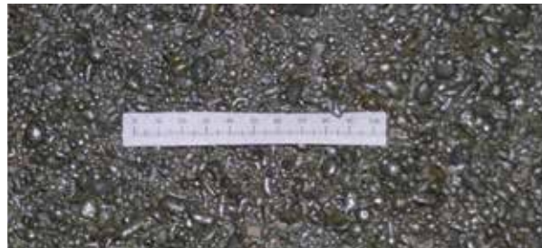
Rys. 6. Uzyskany granulaty o kształcie zbliżonym do globularnego
