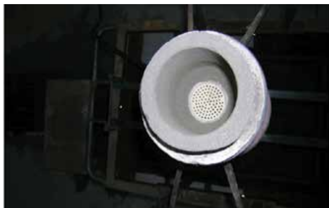
Rys. 7. Ceramiczny filtr odlewniczy zamocowany w tulei, przez który przelewany był stopiony metal
