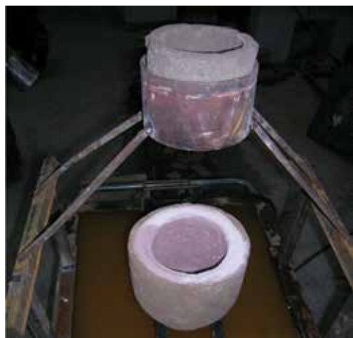
Rys. 3. Zmodyfikowana konstrukcja do granulacji stopów
