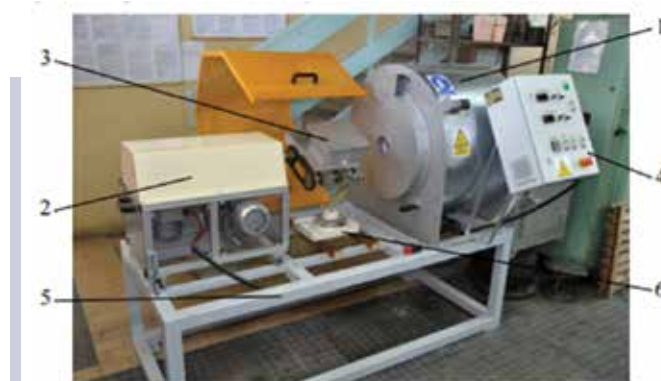
Rys. 2. Wygląd urządzenia do odlewania rotacyjnego znajdującego się na wyposażeniu laboratorium Katedry Procesów Polimerowych Politechniki Lubelskiej: 1 - układ grzewczy, 2 - układ rotacyjny, 3 - forma odlewnicza, 4 - układ sterowania i regulacji, 5 - podstawa, 6 - wentylator
