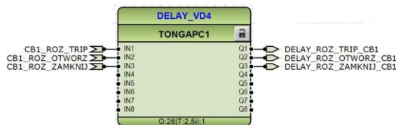
Rys. 6. Funkcja TONGAPC1 realizująca opóźnienie sygnałów sterujących wyłącznikiem [3]
