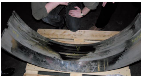
Rys. 3. Uszkodzone elementy łożyska głównego wskutek zacierania czopa w panwi: a) półpanew, b) czop główny wału korbowego [29, 38]
