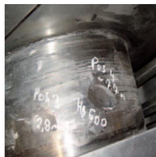
Rys. 3. Uszkodzone elementy łożyska głównego wskutek zacierania czopa w panwi: a) półpanew, b) czop główny wału korbowego [29, 38]
