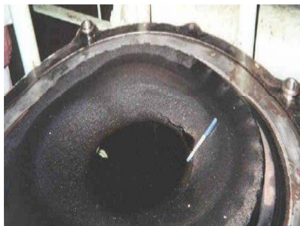
Rys. 4. Uszkodzenie tłoka wskutek wypalenia dziury w jego denku [29, 41]:
