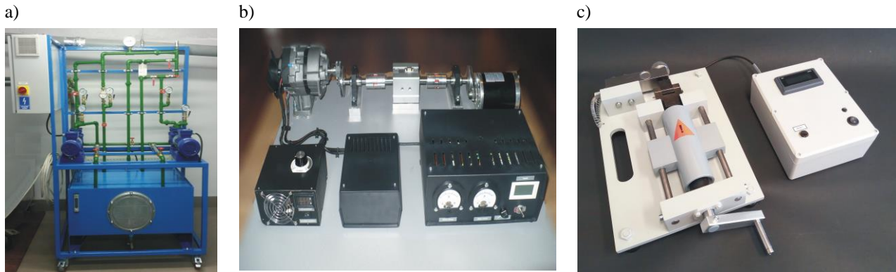
Rys. 5. Stanowiska laboratoryjne zaprojektowane i wykonane w Katedrze Siłowni Morskich i Lądowych wspierające proces szkolenia marynarzy i oficerów działu maszynowego marynarki handlowej: a) widok ogólny stanowiska do badania warunków współpracy pomp wirowych, b) widok ogólny stanowiska do badania elektromechanicznego zespołu napędowego, c) widok ogólny stanowiska do badań wytrzymałościowych w zakresie pomiaru naprężeń z użyciem tensometrów oporowych
