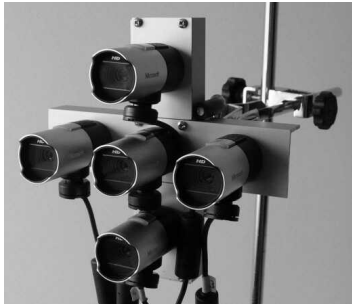
Rys. 1. Układ kamer o nazwie EBCA (Equal Baseline Camera Array) użyty w eksperymentach
