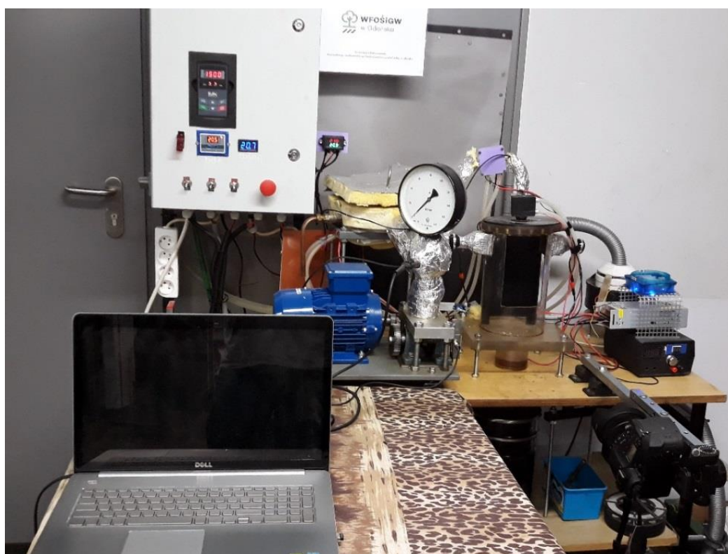
Rys. 2. Widok stanowiska do badania strugi rozpylanego paliwa.
