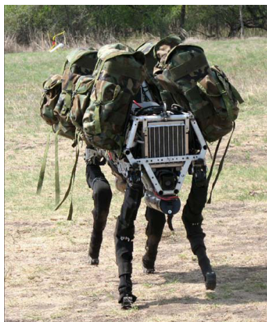
Rysunek 2.8 Robot czworonożny BigDog ( źródło : DARPA licencja : Public Domain).
