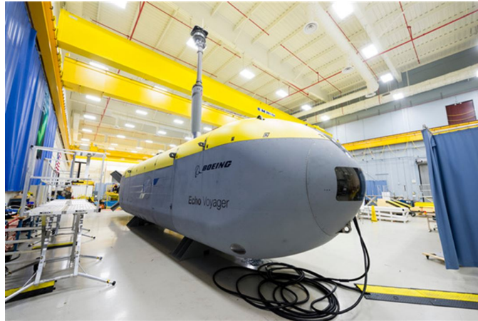
Rysunek 2.4 Autonomiczny robot podwodny Echo Voyager ( źródło: DARPA licencja: Public Domain ).
