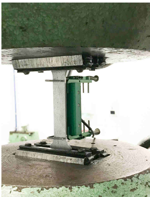
Rys. 5.4. Zdjęcia maszyny wytrzymałościowej: a) widok próbki w szczękach maszyny, b) widok głównej części pomiarowej.
