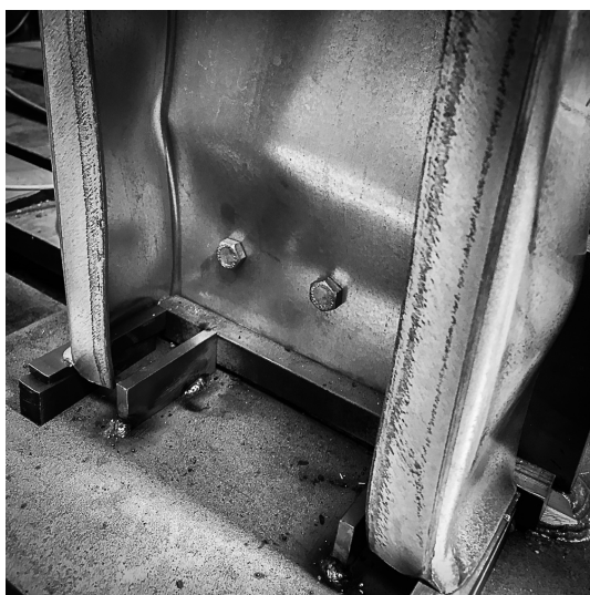
Rys. 6.14. Zdjęcia przedstawiające deformację gałęzi modeli 2 - 8: a) forma zniszczenia, b) uplastycznienie ścianek w podstawie.
