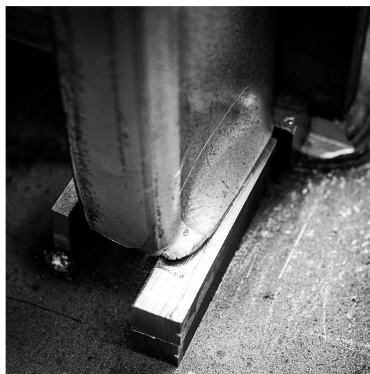
Rys. 6.14. Zdjęcia przedstawiające deformację gałęzi modeli 2 - 8: a) forma zniszczenia, b) uplastycznienie ścianek w podstawie.
