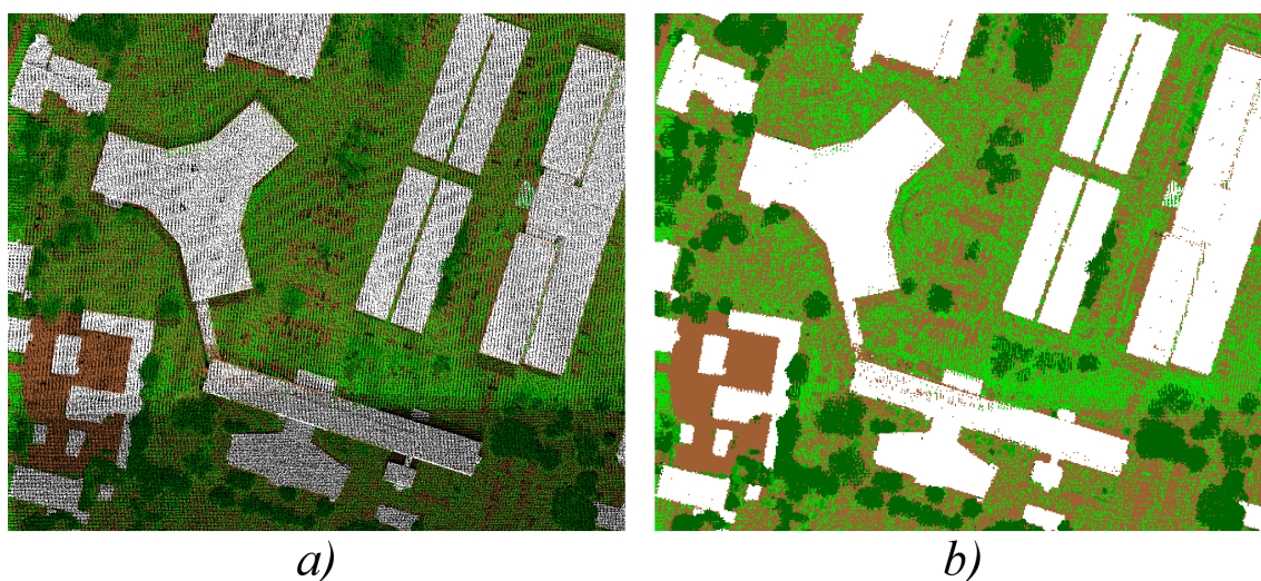
Rys. 38. Dwa różne rezultaty przetworzenia pojedynczego zbioru danych do postaci rastrów o rozdzielczościach 0,25\text{ m} \times 0,25\text{ m} (a) oraz 0,5\text{ m} \times 0,5\text{ m} (b)
