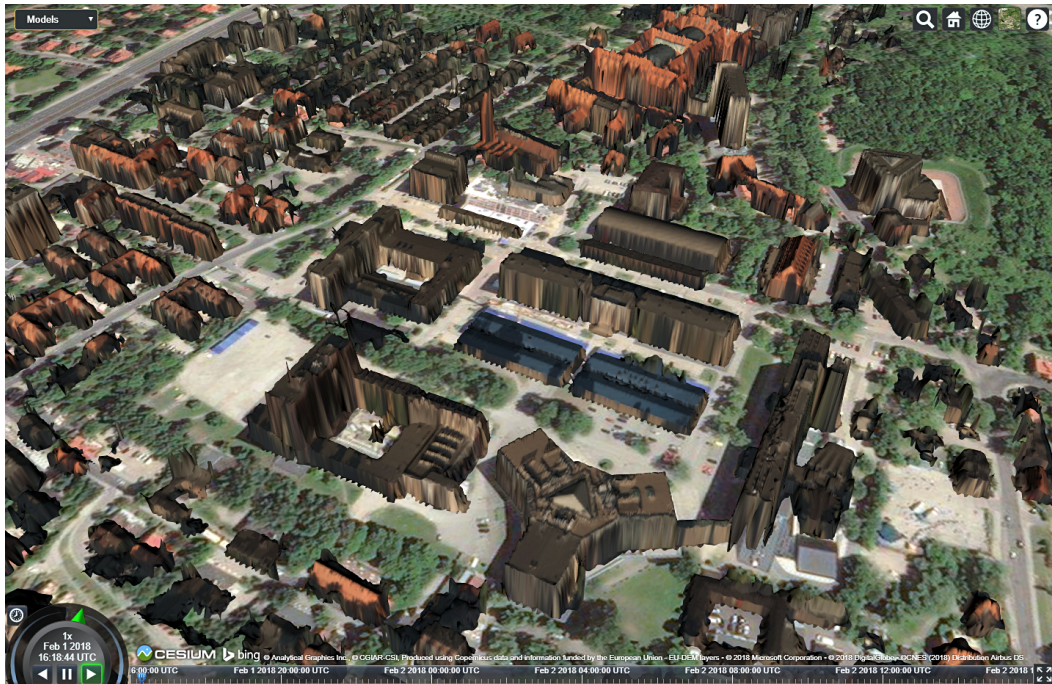
Rys. 58. Modele budynków uzyskane na podstawie opisanych metod, umieszczone w trójwymiarowym systemie informacji przestrzennej Cesium
