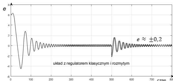
Rys. 10. Przebieg uchybu regulacji dla zadanej różnicy temperatur - regulator klasyczny i rozmyty
