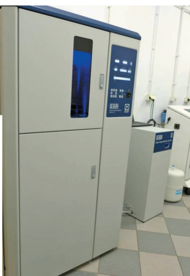
Fot. 6. Komora do testów świetlnych - wezerometr Q-SUN Xenon Test Chamber Xe-2 HS
