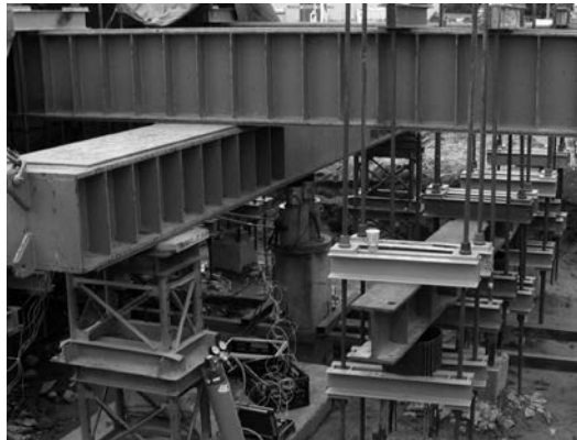
Rys. 2. Zdjęcia z próbnych obciążeń pali prefabrykowanych
