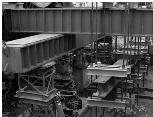
Rys. 2. Zdjęcia z próbnych obciążeń pali prefabrykowanych
