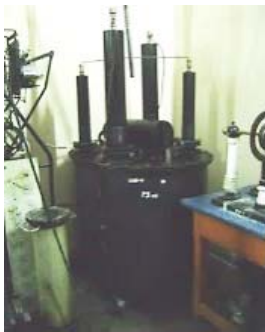
Rys. 8. Transformator 150 kV firmy Siemens-Schuckert znajdujący się obecnie w gmachu głównym Politechniki Lwowskiej [6]
