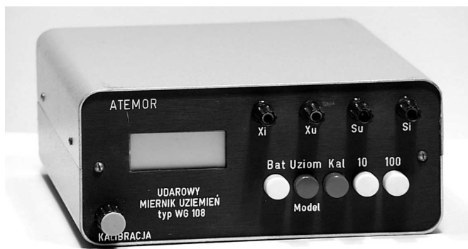
Rys. 3. Widok miernika udarowego uziemień WG-108 wyprodukowanego przez firmę ATEMOR z Gdyni
