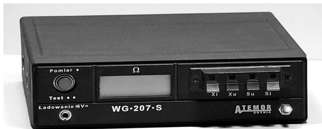
Rys. 4. Udarowy miernik uziemień z serii WG-207
