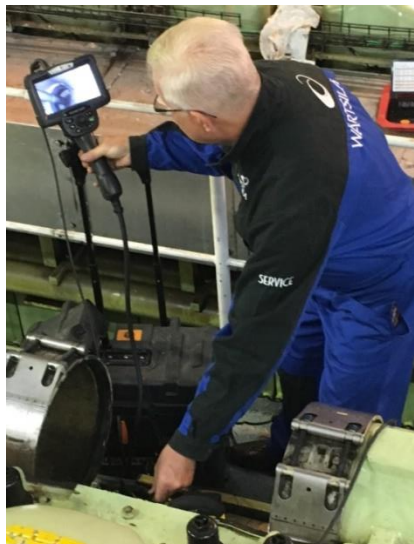
Rys. 7. Sposób wprowadzenia sondy inspekcyjnej wideoendoskopu Everest XLG3 do przestrzeni cylindrowej silnika okrętowego firmy MAN typu 10L32/44CR przez gniazda otwartych zaworów dolotowych: a) dostęp do gniazd zaworowych dolotowych układu cylindrowego nr 5 przez zdemontowaną sekcję kanału powietrza dolotowego, b) gniazda zaworów dolotowych układu cylindrowego nr 5
