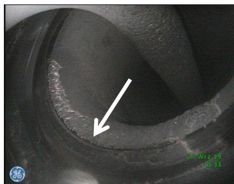
Rys. 8. Dolna płyta głowicy silnika okrętowego firmy MAN typu 10L32/44CR – otwarty zawór wylotowy, widoczna przylgnia grzybka zaworowego (a) i gniazdo zaworowe (b)
