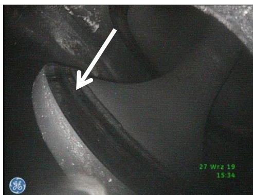
Rys. 8. Dolna płyta głowicy silnika okrętowego firmy MAN typu 10L32/44CR – otwarty zawór wylotowy, widoczna przylgnia grzybka zaworowego (a) i gniazdo zaworowe (b)
