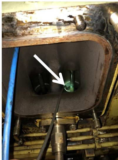
Rys. 7. Sposób wprowadzenia sondy inspekcyjnej wideoendoskopu Everest XLG3 do przestrzeni cylindrowej silnika okrętowego firmy MAN typu 10L32/44CR przez gniazda otwartych zaworów dolotowych: a) dostęp do gniazd zaworowych dolotowych układu cylindrowego nr 5 przez zdemontowaną sekcję kanału powietrza dolotowego, b) gniazda zaworów dolotowych układu cylindrowego nr 5
