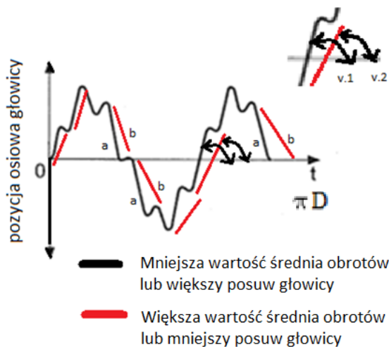
Rys. 28 Trajektorie ziarna ściernego uzyskiwana w trakcie gładzenia „VH” ze zmienną kinematyką
