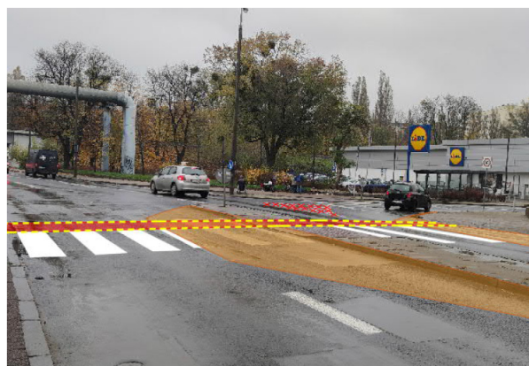
Rys. 12. Schemat proponowanych zmian separacji ruchu w obrębie przejścia dla pieszych na ul. Miszewskiego Źródło: opracowanie własne
