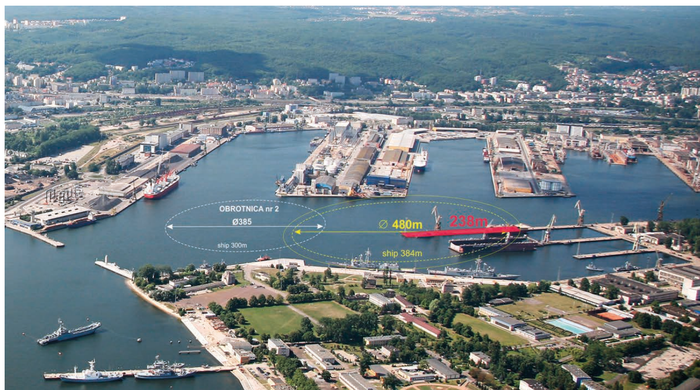
Rys. 2. Koncepcja przebudowy obrotnicy nr 2 w MPG [7]
