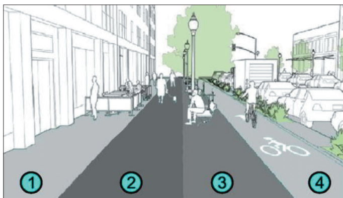
Rys. 7. Podział chodnika na strefy: 1) strefa obsługująca pierzeję budynku, 2) strefa użytkowa chodnika dla ruchu pieszego, 3) strefa użytkowa ulicy, 4) strefa buforowa chodnika Źródła: [22], [28]
