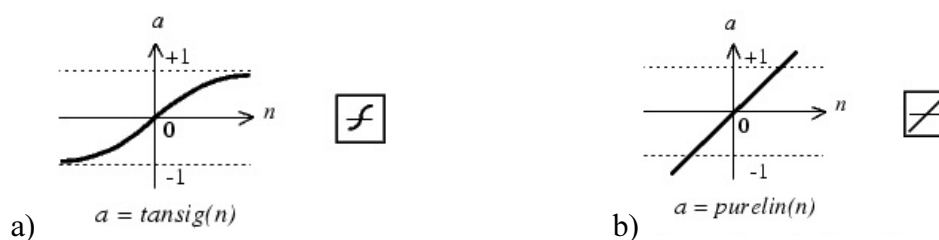
Rys.45 Funkcje aktywacji sieci, a) warstwa 1: f . tangensoidalna, b) warstwa 2: f . liniowa
