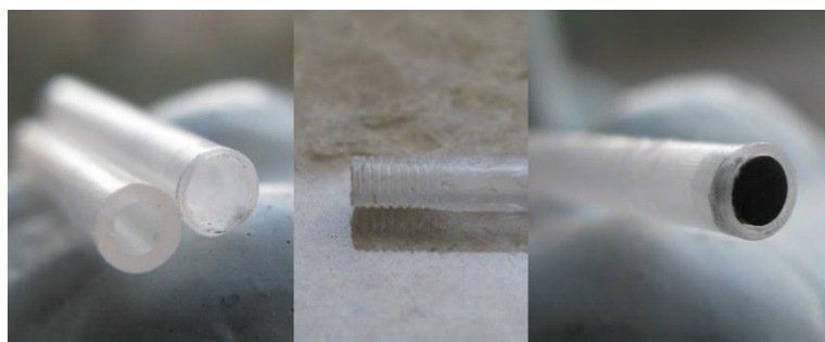
Zdjęcie 14. Przygotowanie obudowy elektrod pomiarowych.
