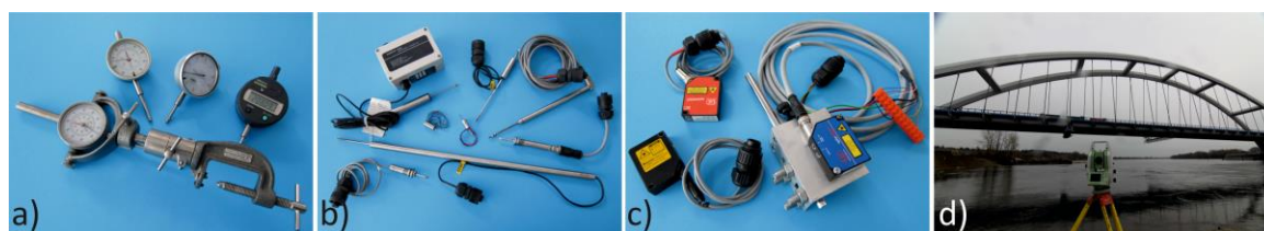
Rysunek 1.4 Czujniki do pomiaru przemieszczeń a) mechaniczne- zegarowe analogowe i cyfrowe b) indukcyjne c) interferometry laserowe d) geodezyjne- tachimetr
