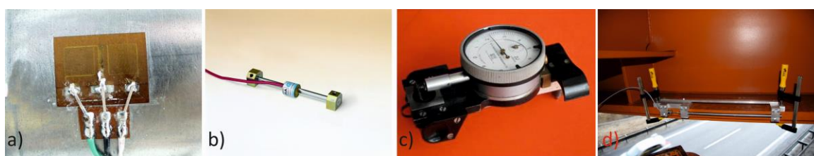
Rysunek 1.5 Czujniki do pomiaru odkształceń a) tensometr elektrooporowy b) tensometr strunowy (źródło: Neostrein) c) ekstensometry mechaniczny d) ekstensometry indukcyjne
