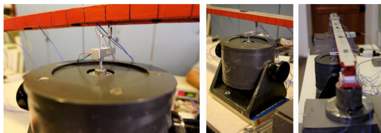
Rysunek 4.13 Sposób połączenia wzbudnika z belką z jednoczesnym pomiarem siły
