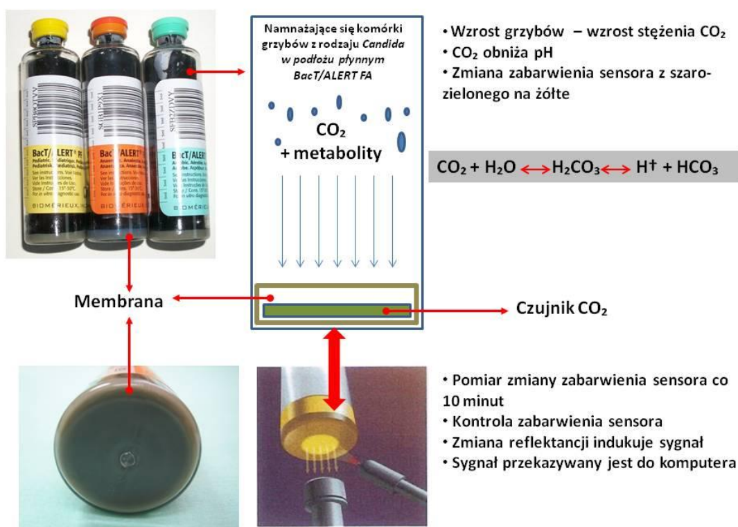
Rycina 1 Zasada detekcji grzybów z rodzaju Candida w próbkach krwi – system BacT/ALERT® 3D (rysunek własny).
