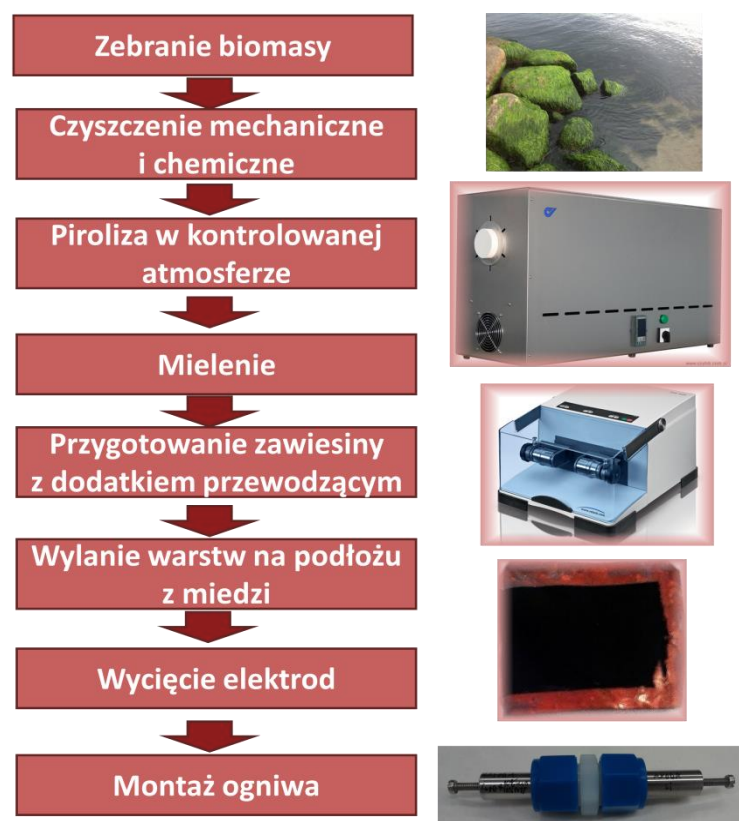
Rys. 9 Schemat procesu przygotowania materiału elektrodowego do testów elektrochemicznych
