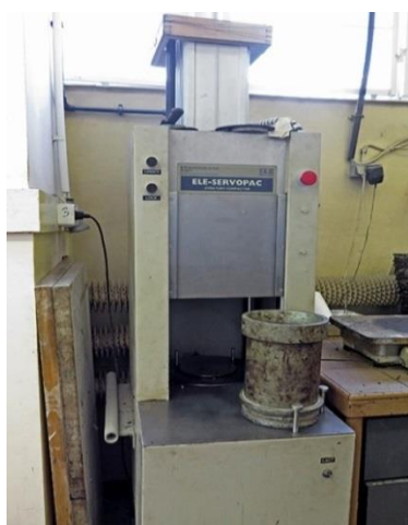
Rysunek 4.12. Prasa żyratorowa i zasada jej działania
