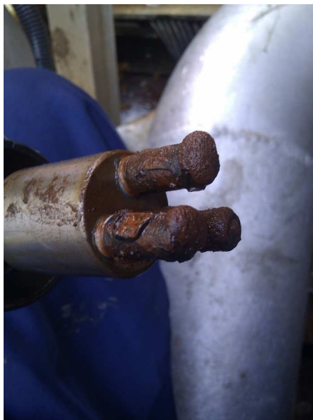
Rys. 7. Stan czujnika po 3 miesięcznej ekspozycji w środowisku solanki, automatyczny system monitorowania korozji.
