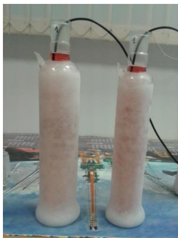
Rysunek 69. Stanowisko do porównania czasu utrzymania pożądanego temperatury napoju w zależności od grubości materiału PCM – eksperyment 3
