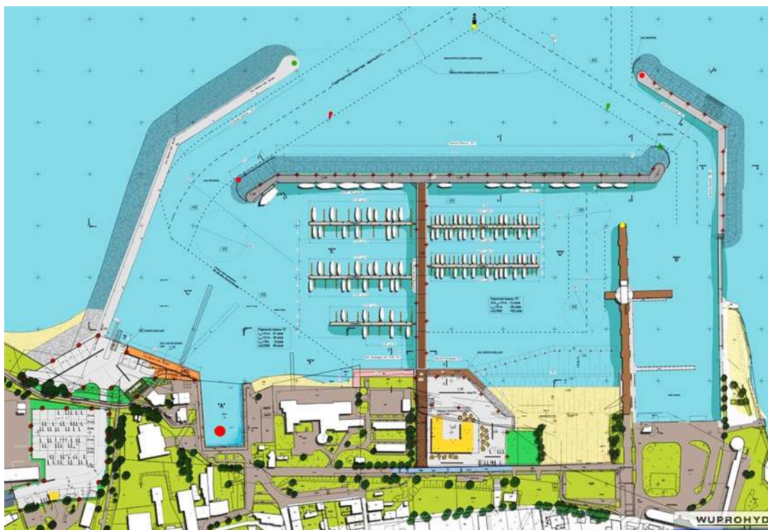
Ryc. 14. Planowa przebudowa portu jachtowego i przedłużenie falochronów. Czerwony punkt wskazuje port rybacki.
