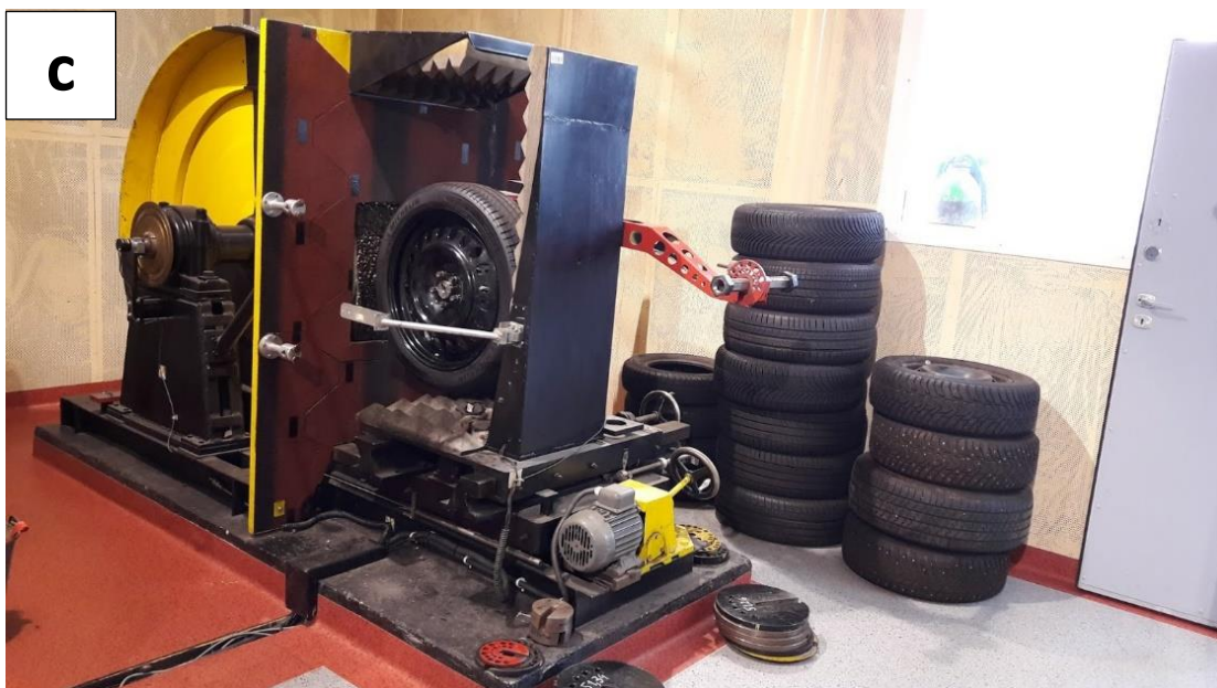
Rysunek 39. Schemat budowy maszyny bieżnej do badania oporu toczenia opon samochodowych (a) [2], maszyny bieżne będące na wyposażeniu Zespołu Pojazdów Politechniki Gdańskiej: bęben o średnicy 2 m (b), bęben o średnicy 1,7 m (c) (materiał własny)
