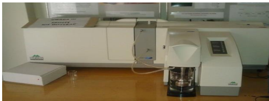
Rys. 3.13. Granulometr laserowy firmy Malvern Instruments Ltd 2000 (fot. Marzena Stosik)
