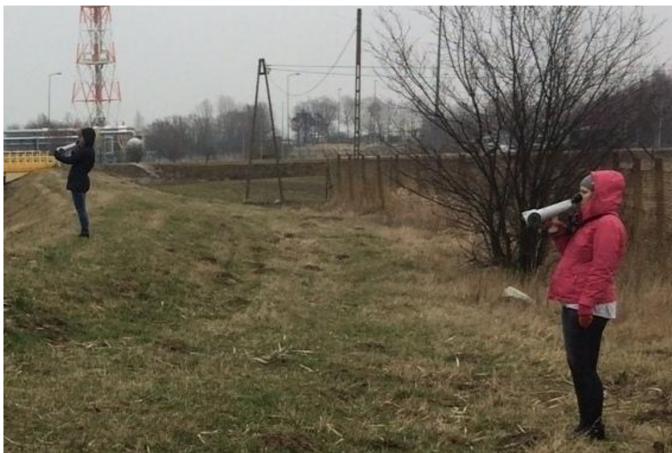
Rysunek 15 Zdjęcie wykonane podczas pomiaru intensywności zapachu przeprowadzonego z wykorzystaniem olfaktometrów terenowych Nasal Ranger
