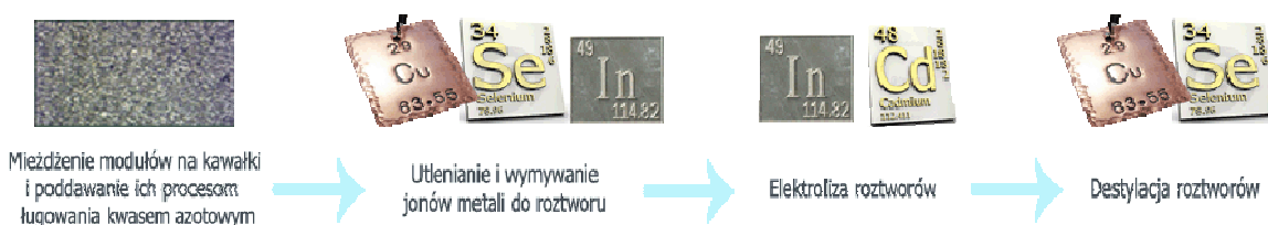
Rysunek 8 Schemat procesu recyklingu ogniw cienkowarstwowych na bazie CIGS [42]
