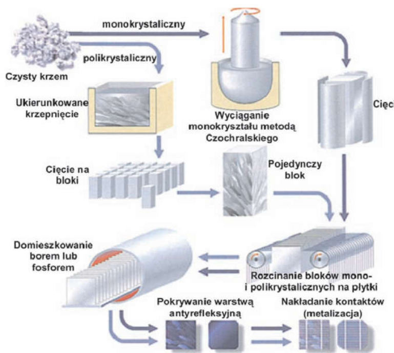
Rysunek 3 Wytwarzanie mono- i polikrystalicznych krzemowych ogniw fotowoltaicznych [13]
