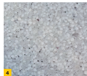
FOT. 1–4. Zróżnicowanie wizualne posadzki typu lastrico w zależności od rodzaju kruszywa: bazaltowe (1), kwarcowe (2), granit z marmurem (3), dolomit drobny (4);
