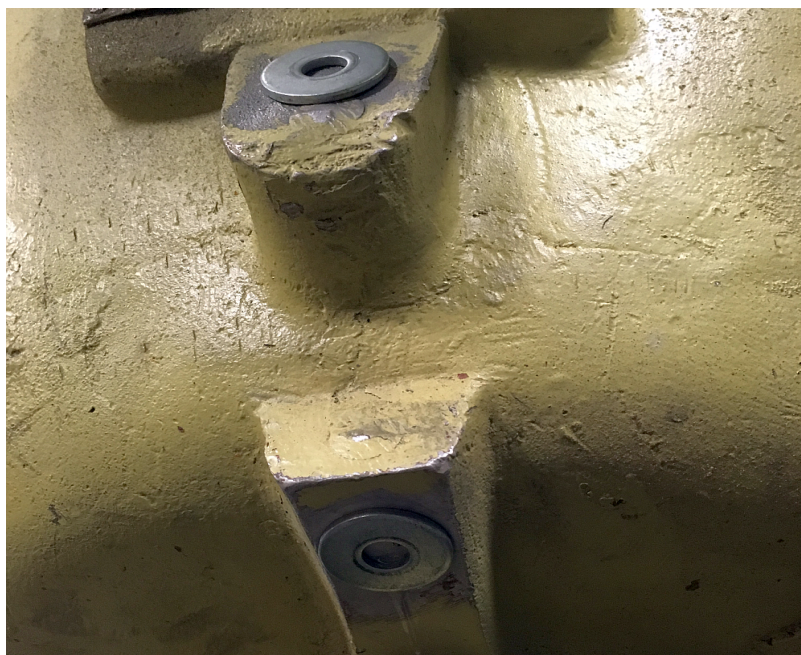
Rys. 3.12. Sposób przygotowania punktów pomiaru drgań w płaszczyznach pionowej i poziomej na amagnetycznej (aluminiowej) obudowie przekładni redukcyjnej silnika Zvezda M503 poprzez przyklejenie stalowych podkładek
