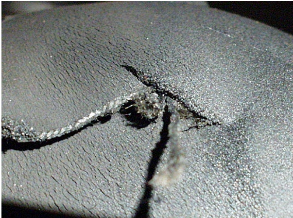
Rys. 2.1. Uszkodzenia zmęczeniowe wałów napędowych statków:
