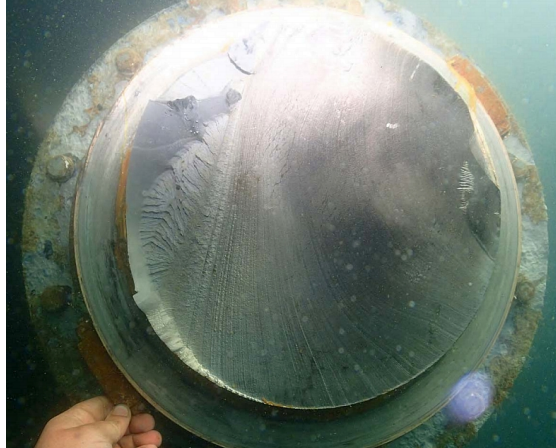
Rys. 2.1. Uszkodzenia zmęczeniowe wałów napędowych statków:
