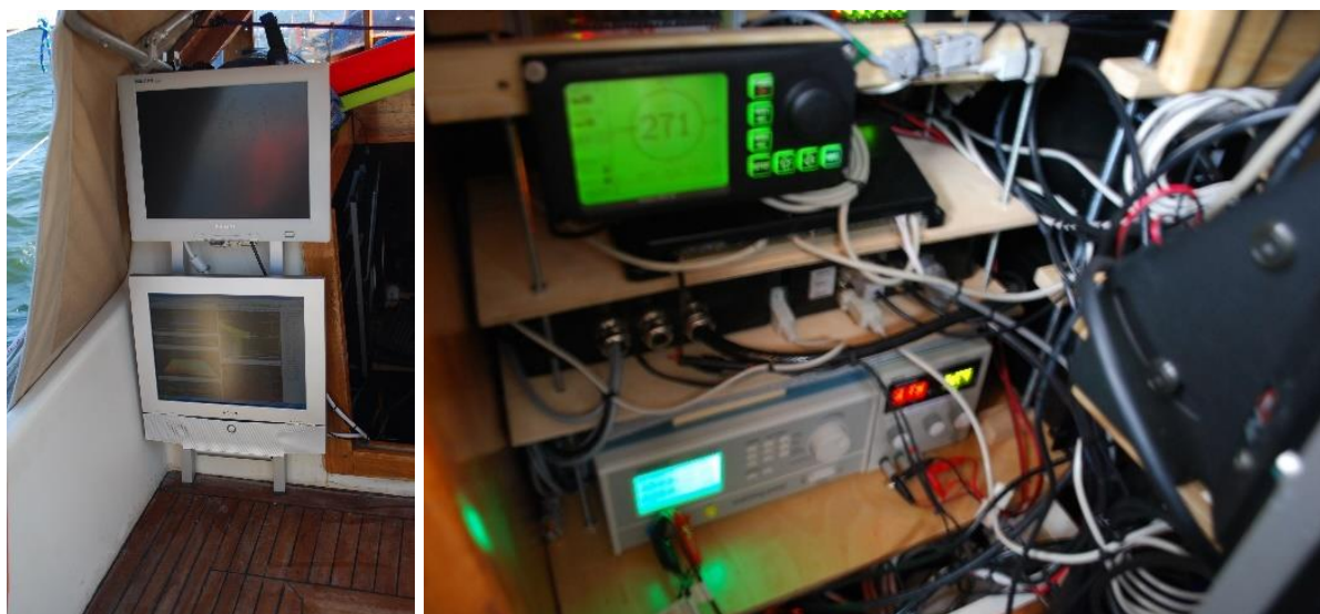
Rysunek 5-66 Zestaw monitorów przeznaczonych dla sternika, wyświetlacz GPS oraz urządzenia pomiarowe wewnątrz jednostki pomiarowej
