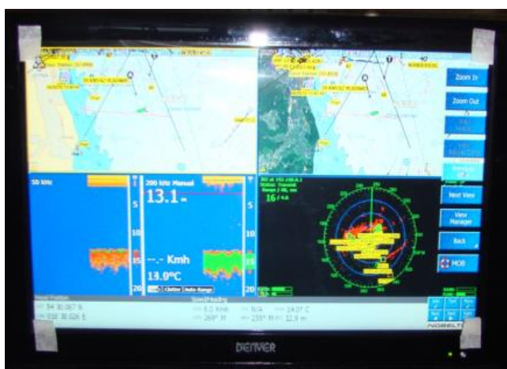
Rysunek 5-67 Antena SEAPATH 300 od systemu GPS (górny obraz) oraz wyświetlacz z oprogramowaniem nawigacyjnym – echosonda 50/200kHz, radar, AIS, mapa nawigacyjna (dolny obraz)
