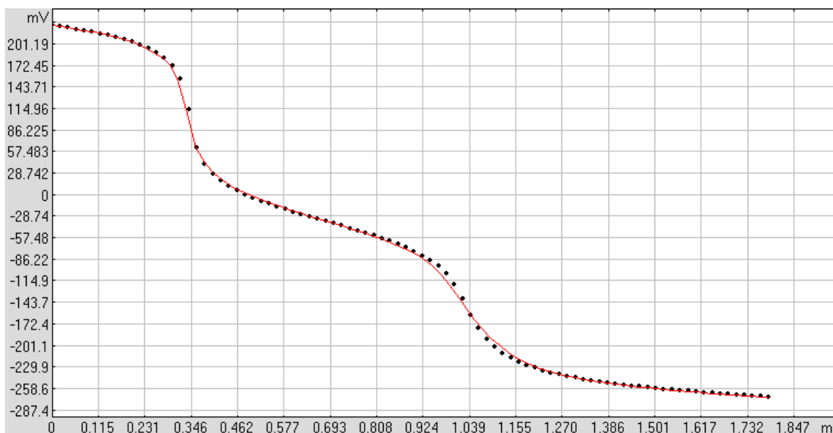
Rys. 65. Miareczkowanie roztworu liganda 4(5)-( \beta -hydroksytylo)imidazolu roztworem \text{NaOH} . Zależność \text{SEM}(V_{\text{NaOH}}) wraz z dopasowaną krzywą.
