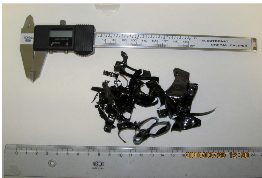
Rys. 12. Próbkę szybko chłodzone formujące się w postaci wstążek.
