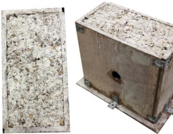
Fig. 6. Ready mass in the mold. Source: Authors' materials Ryc. 6. Gotowa masa w formie. Źródło: Opracowanie własne
