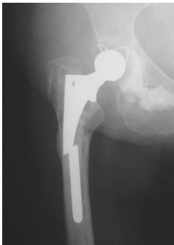
Rysunek 12. Uszkodzony mechanicznie implant stawu biodrowego [65]
