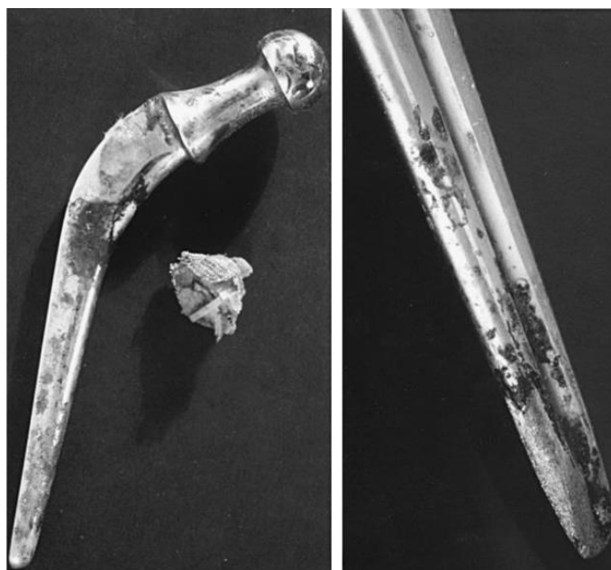
Rysunek 2. Implant stawu biodrowego ze stali austenitycznej z widocznymi uszkodzeniami korozyjnymi [10]
