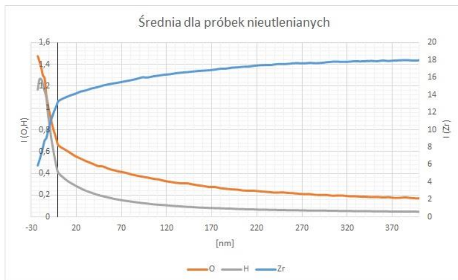
Rysunek 4.3 – Średnia wyników badania GDOES próbek nieutlenionych.
