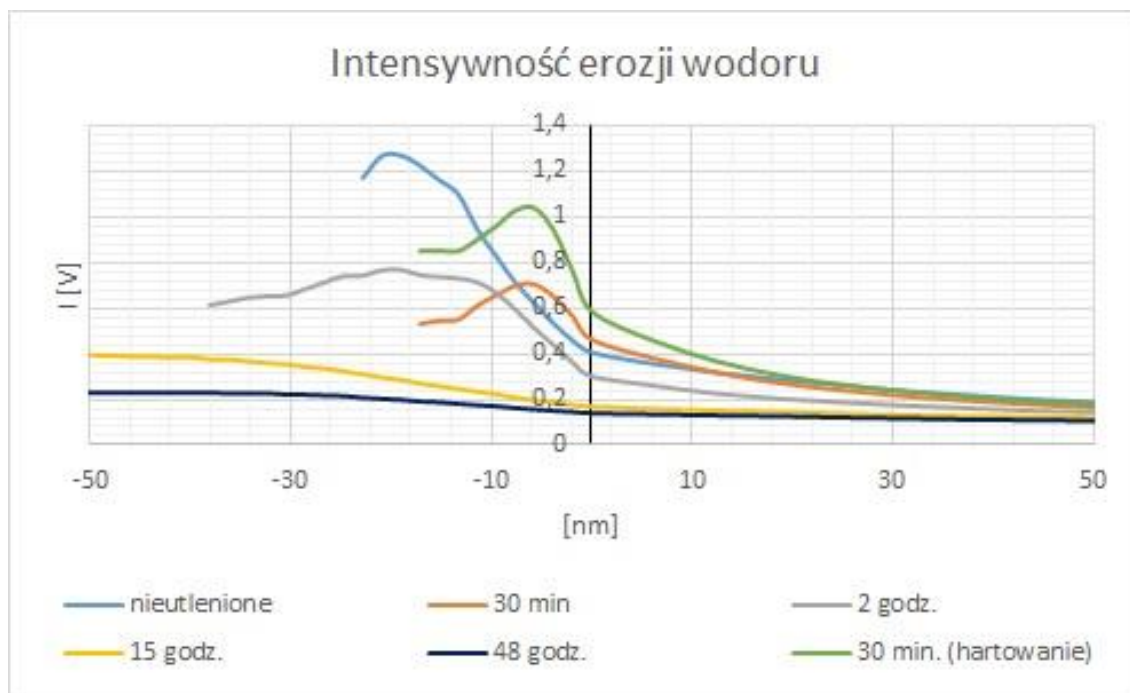
Rysunek 4.13 - Wyniki pomiarów intensywności erozji wodorowej dla próbek utlenianych w powietrzu w 673 K.
