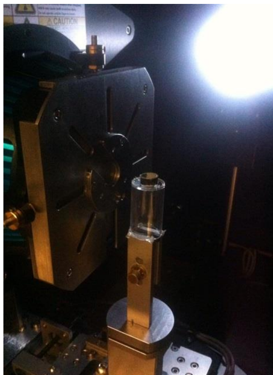
Rysunek 3.10 – przykład skanowania próbki utlenionej w 1373 K tomografem X-ray Versa XRM-500 (Zeiss-Xradia).
