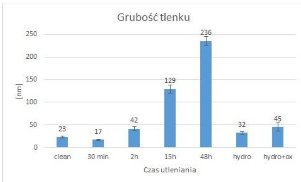
Rysunek 4.11 – Porównanie grubości wytworzonej podczas utleniania w 673 K warstwy tlenkowej pokazane dla różnych czasów utleniania oraz po nawodorowaniu.
