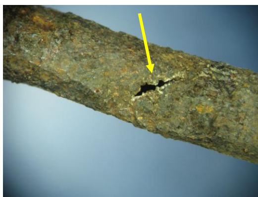
Rys. 4.47. Fragment przewodu hamulcowego z widocznym uszkodzeniem
