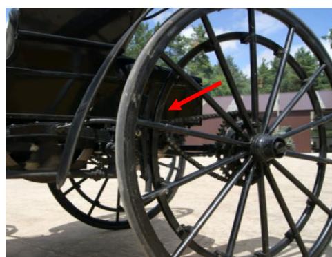
Rys. 1.2. Widok elementów układu hamulcowego tylnego lewego koła pojazdu Holsman model 3 rok produkcji 1905
