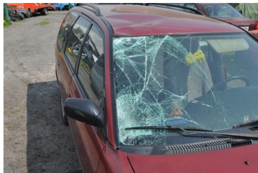
Rys. 4.56. Widoczne uszkodzenia szyby przedniej i dachu po potrąceniu rowierzysty
