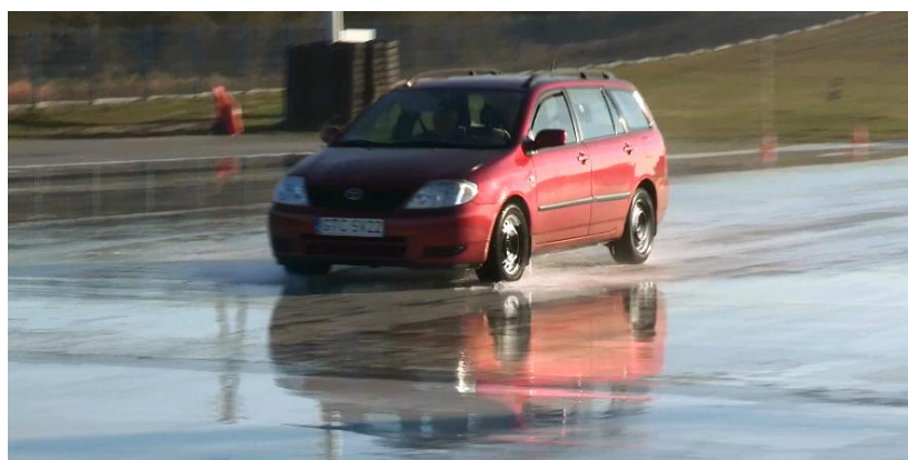
Rys.8.45. Widok samochodu w końcowej fazie hamowania, układ hamulcowy sprawny, układ ABS tak
