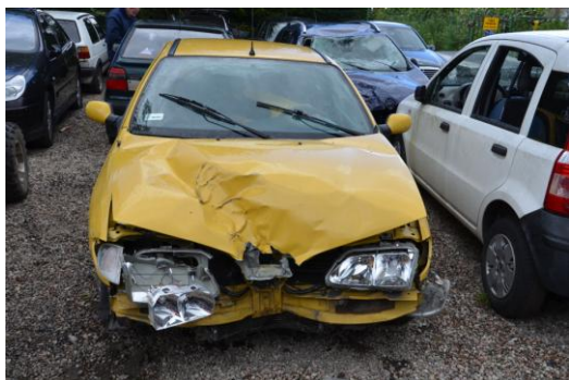
Rys. 4.67. Przód samochodu Renault po czołowym uderzeniu w drzewo
