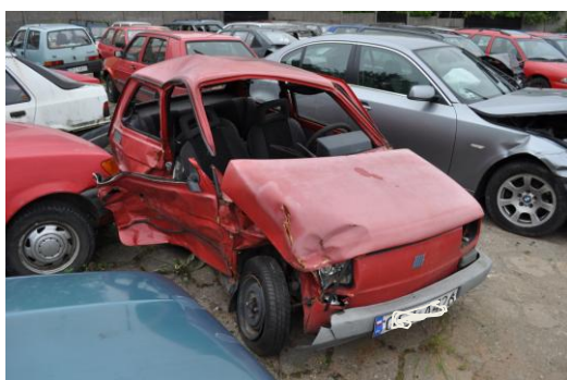
Rys. 4.37. Przód i prawy bok samochodu Fiat w stanie powypadkowym
