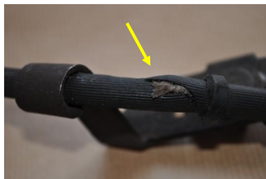
Rys. 4.62. Pęknięcie elastycznego przewodu hamulcowego
