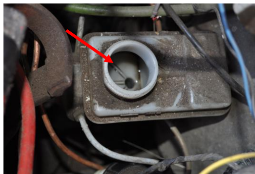
Rys. 4.44. Brak płynu hamulcowego w zbiorniczku wyrównawczym
