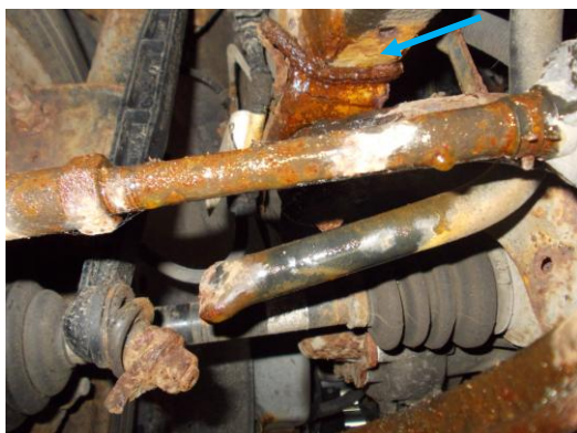
Rys. 5.10. Widoczne uszkodzenie przewodu hamulcowego nastąpiło podczas okresowego badania technicznego
