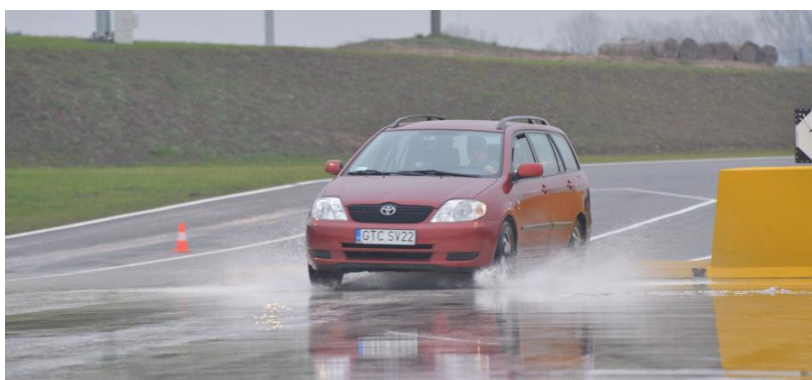
Rys.8.44. Widok samochodu w początkowej fazie hamowania, układ hamulcowy sprawny, układ ABS tak
