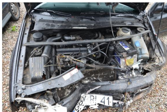
Rys. 4.2. Widok z góry uszkodzonego przodu samochodu po otwarciu komory silnika
