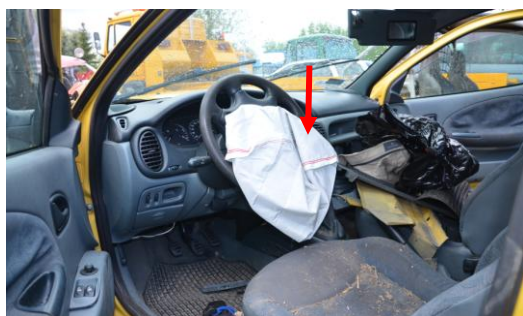
Rys. 4.20. Wystrzelona poduszka powietrzna kierowcy w samochodzie Renault
