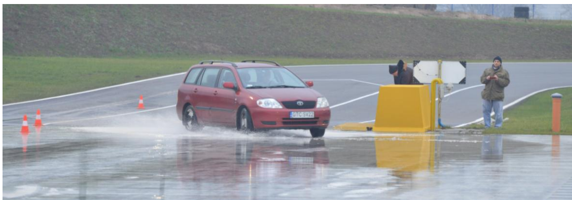
Rys. D.7. Widok samochodu na płycie poślizgowej po zaburzeniu ruchu osi tylnej
