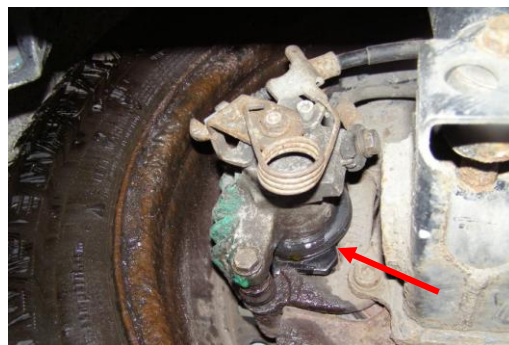
Rys. 5.15. Widoczny wyciek płynu hamulcowego z zacisku tylnego lewego koła w samochodzie Audi A4
