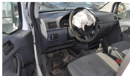
Rys. A.4. Wystrzelona poduszka kierowcy
