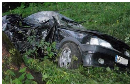
Rys. 4.80. Widok uszkodzonego samochodu Peugeot po uderzeniu bokiem w drzewo (Rys. źródło http://expresskaszubski.pl )
