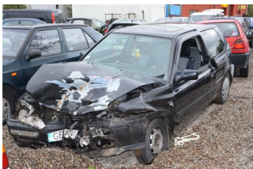
Rys. 4.49. Przód i lewy bok samochodu Volkswagen po zderzeniu czołowym
