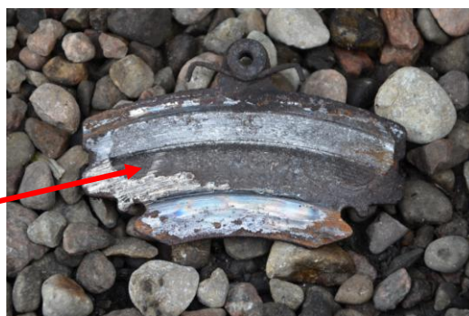
Rys. 4.78. Klocek hamulcowy pozbawiony całkowicie materiału ciernego
