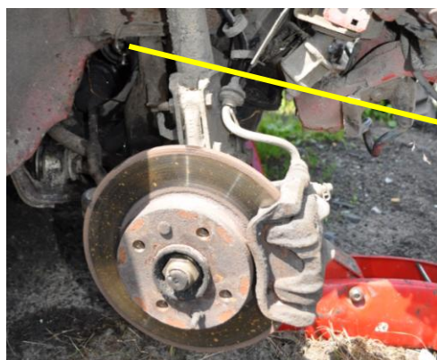
Rys. 4.45. Widoczny wyciek płynu hamulcowego z metalowego przewodu
