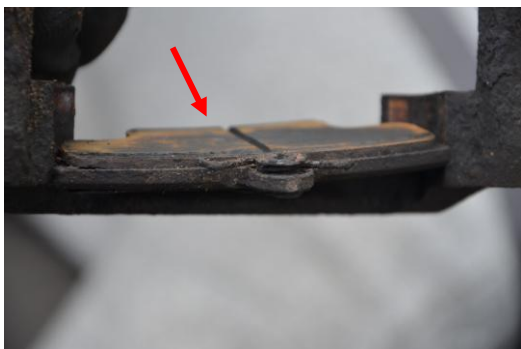
Rys. 4.73. Widok zużytego, zewnętrznego klocka hamulcowego przedniego lewego koła
