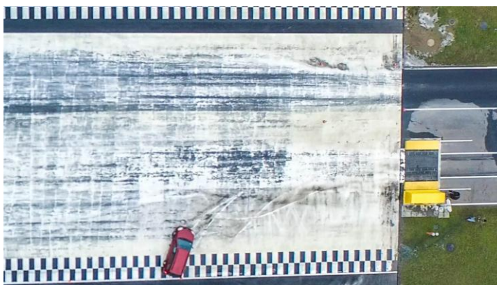
Rys. D.20. Zdjęcie położenia samochodu po zatrzymaniu się na płycie poślizgowej z prędkości 40 km/h
