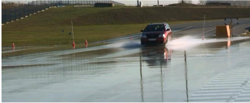
Rys.8.65. Widok samochodu w początkowej fazie hamowania, układ hamulcowy niesprawny, bez ABS
