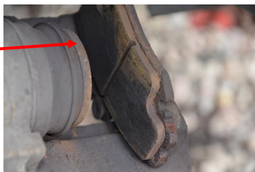
Rys. 4.76. Klocek hamulcowy wykazujący normalne ślady zużycia eksploatacyjnego
