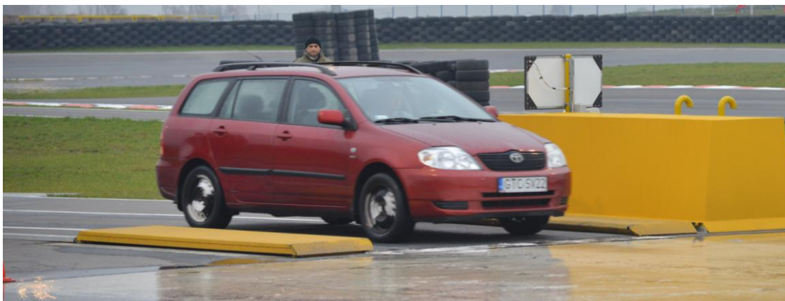
Rys. D.11. Koła osi przedniej znajdują się na „płyce dynamicznej”
