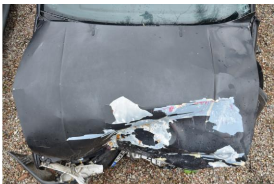
Rys. 4.1. Widok z góry uszkodzonego przodu samochodu z pokrywą komory silnika
