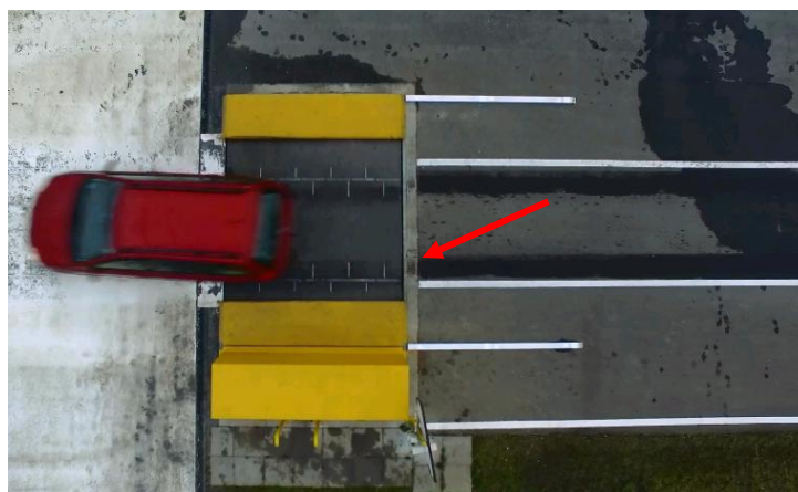
Rys. D.3. Tylna część samochodu jeszcze nie zjechała „płyty dynamicznej” – końcowa faza przesunięcia płyty
