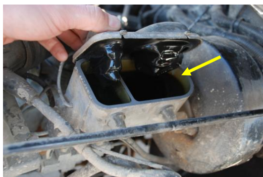
Rys. 4.99. Odpowiedni poziom płynu hamulcowego w zbiorniczku wyrównawczym
