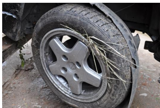
Rys. 4.26. Wtłoczona trawa i ziemia między oponą i obręczą samochodu
