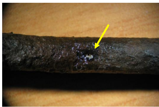
Rys. 4.58. Widoczne uszkodzenie przewodu po wymontowaniu z pojazdu
