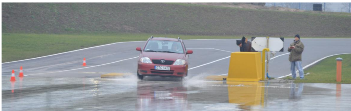
Rys. D.6. Widok samochodu na „płycie dynamicznej” po zaburzeniu ruchu kół tylnych
