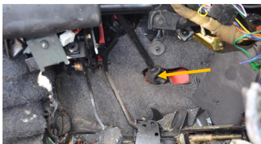
Rys. 4.31. Uszkodzona kolumna kierownicza samochodu Fiat
