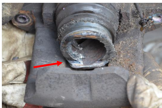
Rys. 4.71. Widok uszkodzonego tłoczka zacisku hamulcowego przedniego lewego koła
