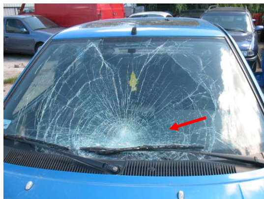
Rys. 4.13. Widok uszkodzonej szyby przedniej samochodu Ford od potrącenia pieszego
