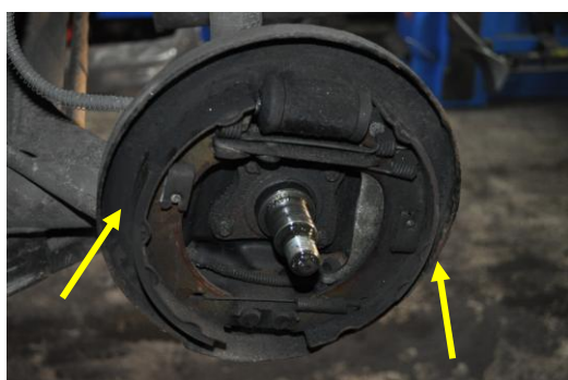
Rys. 4.63. Zabrudzone szczęki hamulcowe w tylnym lewym kole
