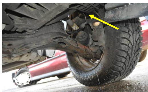
Rys. A.11. Wyciek płynu z przewodu hamulcowego przedniego lewego koła
