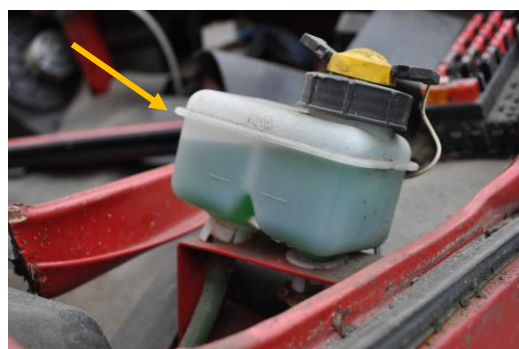
Rys. 4.38. Odpowiedni poziom płynu hamulcowego w zbiorniczku wyrównawczym
