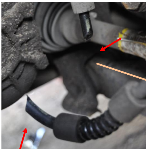
Rys. A.7. Rozdzielony przewód hamulcowy przedniego lewego koła
