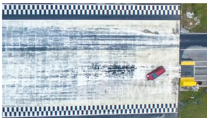
Rys. D.14. Zdjęcie położenia samochodu na płycie poślizgowej, prędkość początkowa 40 km/h
