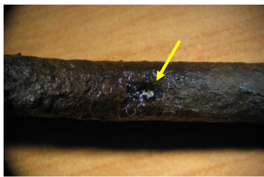
Rys. 4.58. Widoczne uszkodzenie przewodu po wymontowaniu z pojazdu
