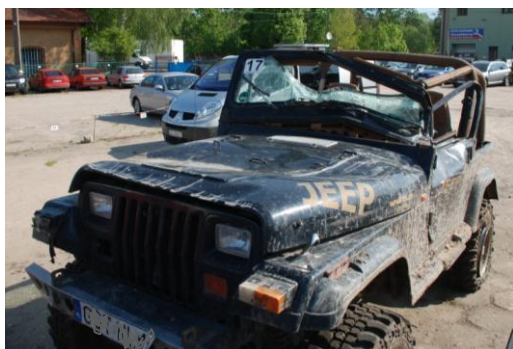
Rys. 4.97. Widok przodu i lewego boku samochodu Jeep po dachowaniu
