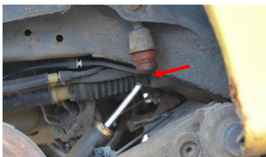
Rys. 4.28. Urwane tłoczisko amortyzatora tylnego prawego w samochodzie Renault
