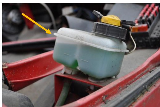
Rys. 4.38. Odpowiedni poziom płynu hamulcowego w zbiorniczku wyrównawczym
