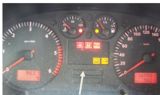
Rys. C.5. Widok tablicy rozdzielczej po zgaśnięciu kontrolki od układu ABS
