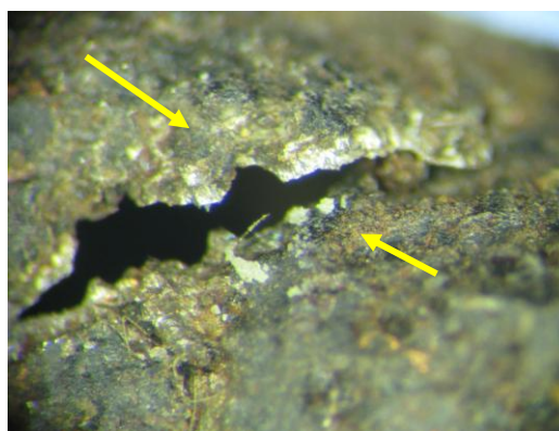
Rys. 4.48. Widoczne w powiększeniu uszkodzenie przewodu hamulcowego
