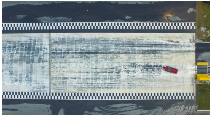
Rys. D.22. Zdjęcie położenia samochodu w wybranym momencie po przesunięciu płyty w lewą stronę
