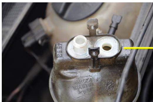
Rys. 4.53. Zbiorniczek płynu hamulcowego uszkodzony w czasie wypadku
