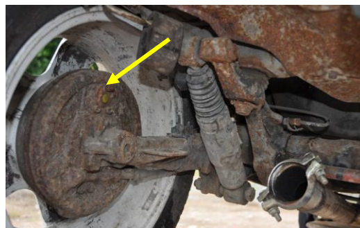
Rys. 4.86. Brak przewodu hamulcowego przy tylnym lewym hamulcu bębnowym
