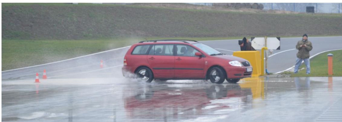
Rys. D.8. Widok samochodu na płycie poślizgowej po obrocie osi tylnej o kąt około 90^\circ
