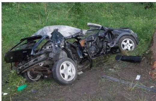
Rys. 4.79. Widok uszkodzonego samochodu Peugeot po uderzeniu bokiem w drzewo (Rys. źródło http://expresskaszubski.pl )
