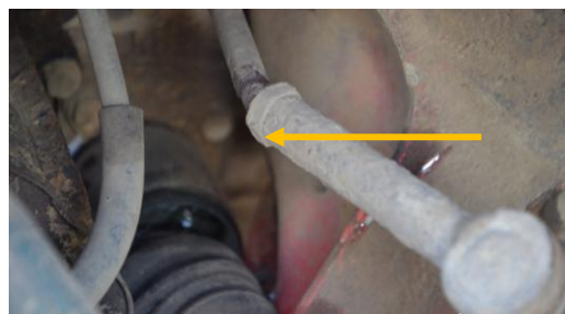
Rys. 4.32. Wygięty lewy drążek kierowniczy samochodu Fiat
