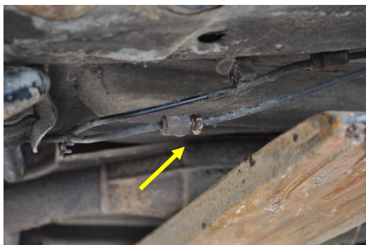
Rys. 4.91. Łączenie metalowego przewodu hamulcowego z którego kapie płyn
