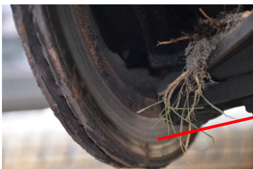
Rys. 4.77. Widok wewnętrznej strony tarczy hamulcowej nadmiernie zużytej
