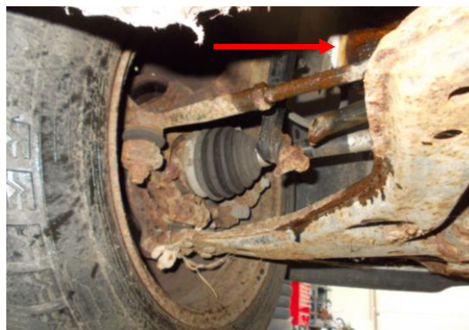
Rys. 5.9. Widoczny wyciek płynu hamulcowego przy przednim lewym kole w samochodzie Opel zaznaczono czerwoną strzałką
