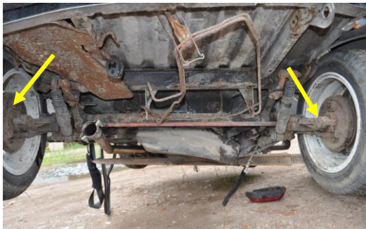
Rys. 4.85. Tylna część podwozia gdzie widać brak przewodów hamulcowych
