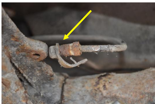
Rys. 4.88. Zaślepiony przewód doprowadzający płyn do tylnego lewego hamulca
