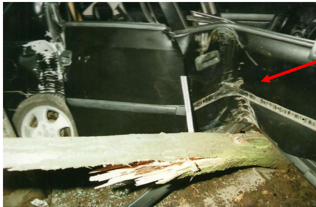
Rys. 4.9. Uszkodzenie nadwozia samochodu Opel w wyniku uderzenia w pień drzewa (fot. wykonana przez funkcjonariusza policji na miejscu wypadku)
