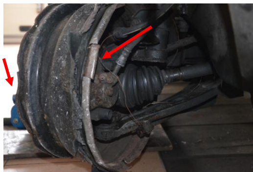
Rys. 4.24. Uszkodzona obręcz koła samochodu Fiat po „wystrzale” opony
