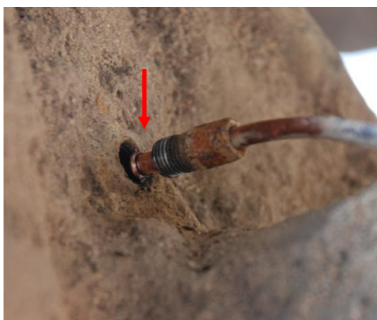
Rys. 4.101. Odkręcony przewód hamulcowy tylnego lewego koła od cylinderka
