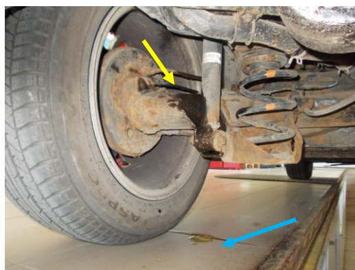
Rys. 5.5. Wyciek płynu hamulcowego z sztywnego przewodu przy tylnym lewym kole (żółtą strzałką zaznaczono skorodowany przewód, a niebieską strzałką wyciekający płyn hamulcowego)
