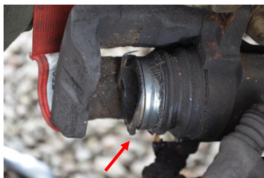
Rys. 4.72. Widok uszkodzonego tłoczka zacisku hamulcowego przedniego lewego koła
