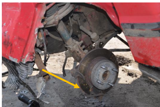
Rys. 4.35. Uszkodzona tarcza hamulcowa przedniego lewego koła samochodu Fiat
