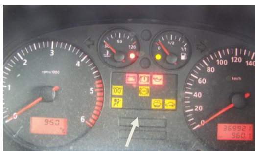
Rys. C.4. Widok świecącej kontrolki układu ABS na tablicy rozdzielczej
