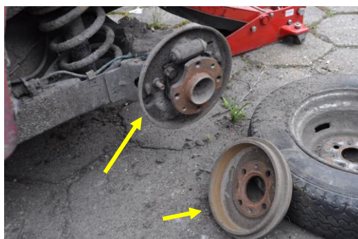
Rys. 4.41. Widok zdemontowanego bębna hamulcowego oraz braku elementów ciernych
