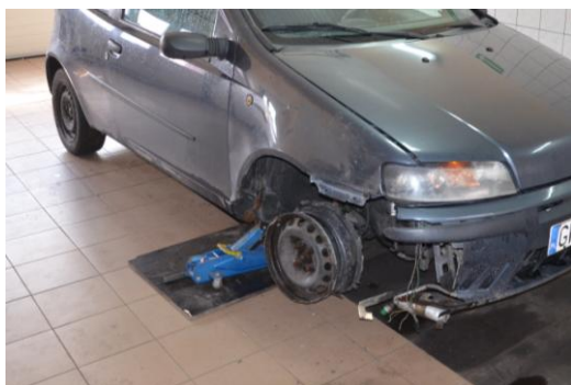
Rys. 4.23. Uszkodzone elementy nadwozia samochodu Fiat w wyniku „wystrzału” opony
