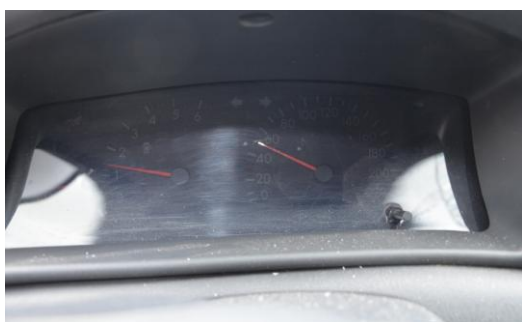
Rys. 4.16. Zatrzymanie wskazówek obrotomierza i prędkościomierza samochodu Toyota
