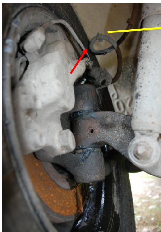
Rys. 4.105. Fragment przewodu gumowego przyległego do wewnętrznej strony opony
