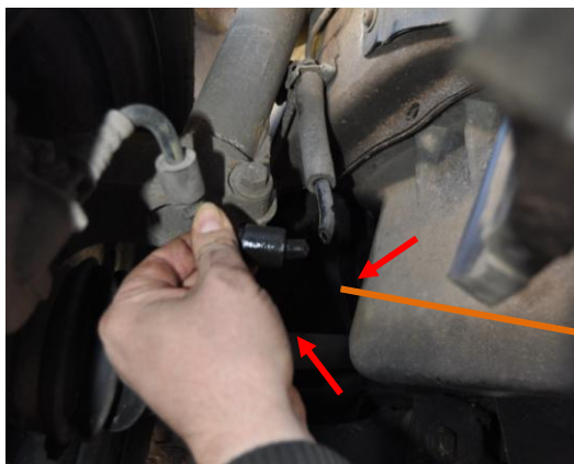
Rys. A.5. Rozdzielony przewód hamulcowy przedniego prawego koła
