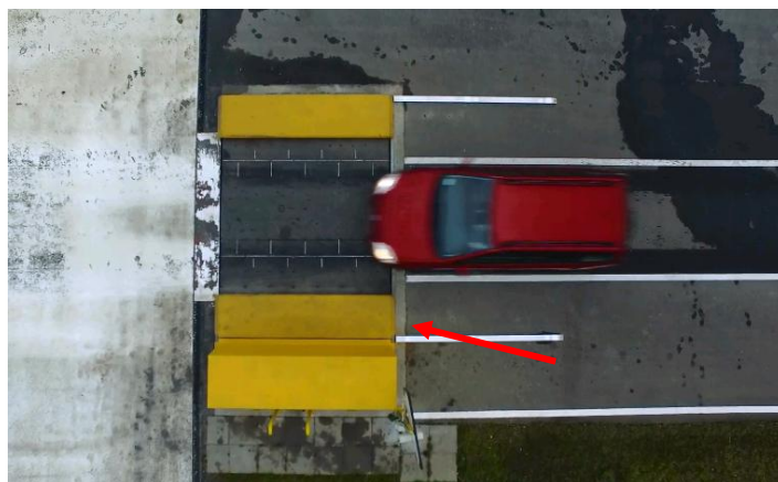
Rys. D.2. Wjazd samochodu na „płyte dynamiczną” – Autodrom Pomorze
