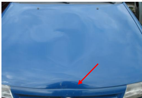
Rys. 9.2. Widok uszkodzonej pokrywy silnika samochodu Opel Astra
