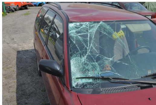
Rys. 4.56. Widoczne uszkodzenia szyby przedniej i dachu po potrąceniu rowerzysty
