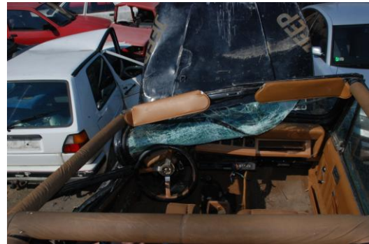
Rys. 4.98. Widok wnętrza samochodu terenowego Jeep po dachowaniu
