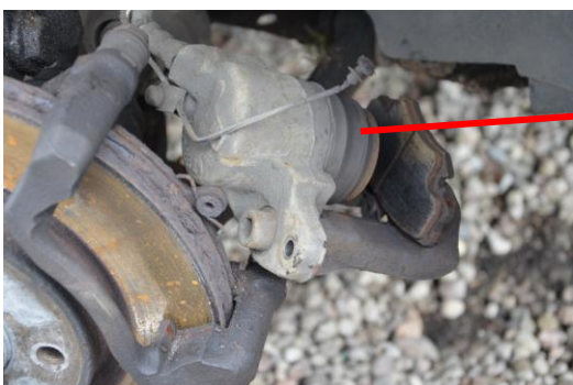
Rys. 4.75. Fragment tarczy hamulcowej oraz zacisk przedniego prawego koła
