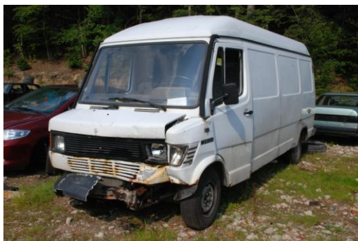
Rys. 4.103. Przód i lewy bok samochodu Mercedes po kolizji drogowej
