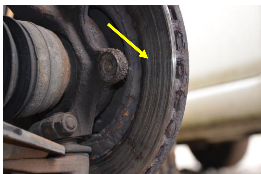
Rys. 4.69. Nadmiernie zużyta wewnętrzna strony tarczy hamulcowej przedniego lewego koła
