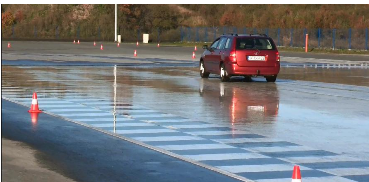
Rys. 8.58. Widok samochodu pod koniec hamowania, układ hamulcowy sprawny, bez ABS
