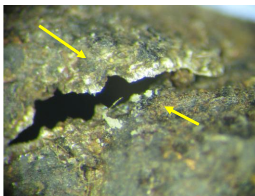
Rys. 4.48. Widoczne w powiększeniu uszkodzenie przewodu hamulcowego
