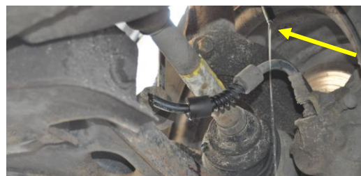
Rys. A.10. Wyciek płynu z przewodu hamulcowego przedniego lewego koła
