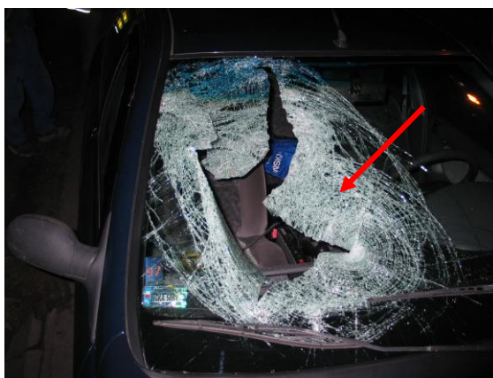
Rys. 4.11. Uszkodzenie przedniej szyby samochodu Renault przez potrąconego pieszego
