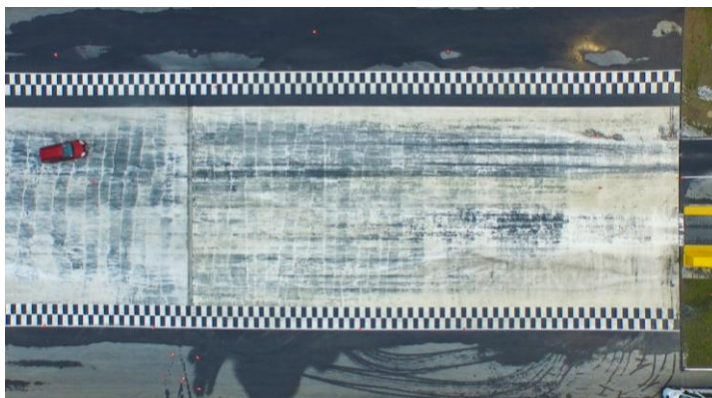
Rys. D.28. Zdjęcie położenia samochodu po zatrzymaniu się na płycie poślizgowej z prędkości 60 km/h
