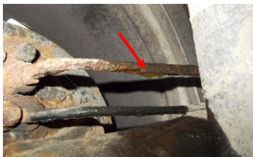
Rys. 5.6. Fragment skorodowanego przewodu hamulcowego, z którego wycieka płyn
