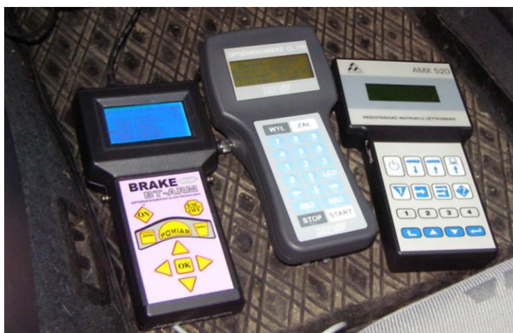
Rys. 8.1. Opóźniomierze użyte do badań (od lewej strony: Brek Test LWS-2/MC, CL 170, AMX 520)
