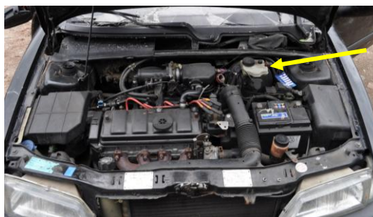
Rys. 4.84. Widok nieuszkodzonej komory silnika oraz zbiorniczek płynu hamulcowego
