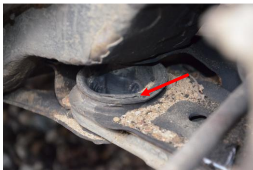
Rys. 4.27. Pęknięcia gumy w tulei metalowo-gumowej wahacza przedniego
