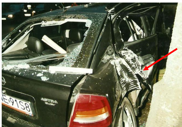
Rys. 4.10. Uszkodzenie nadwozia samochodu Opel w wyniku uderzenia w betonowy słup oświetleniowy (fot. wykonana przez funkcjonariusza policji na miejscu wypadku)
