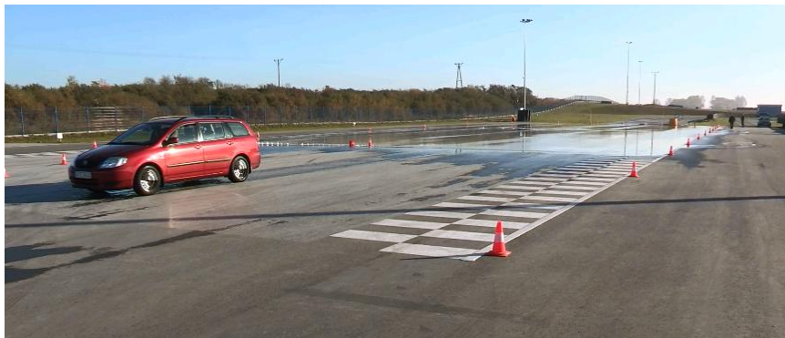
Rys.8.68. Widok samochodu na końcu drogi hamowania, układ hamulcowy niesprawny, bez ABS
