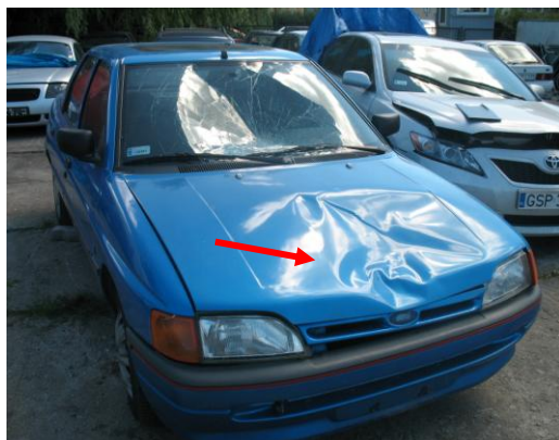
Rys. 4.12. Widok uszkodzonej pokrywy komory silnika samochodu Ford
