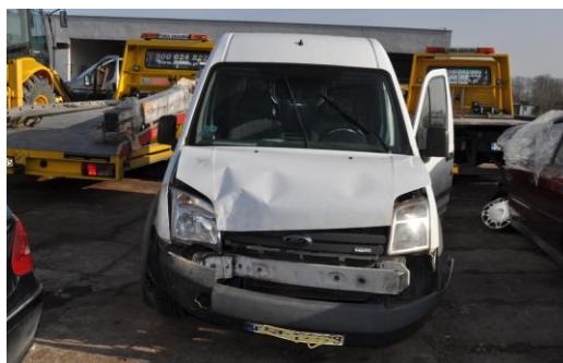
Rys. A.2. Wgnieciona przednia część pokrywy komory silnika i pas przedni
