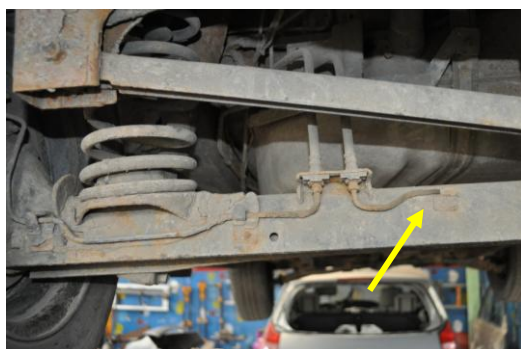
Rys. 4.59. Zaślepiony metalowy przewód hamulcowy znajdujący się na tylnej belce
