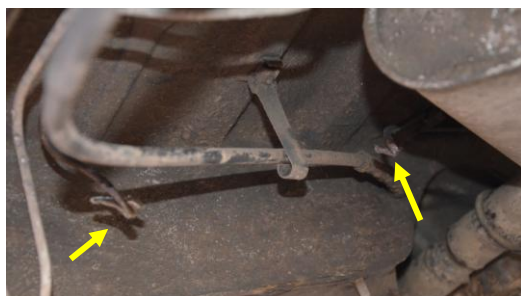
Rys. 4.51. Zaślepiony przewód hamulcowy, metalowy przy tylnym lewym kole
