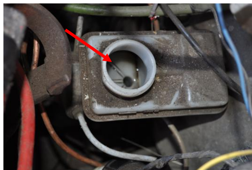
Rys. 4.44. Brak płynu hamulcowego w zbiorniczku wyrównawczym
