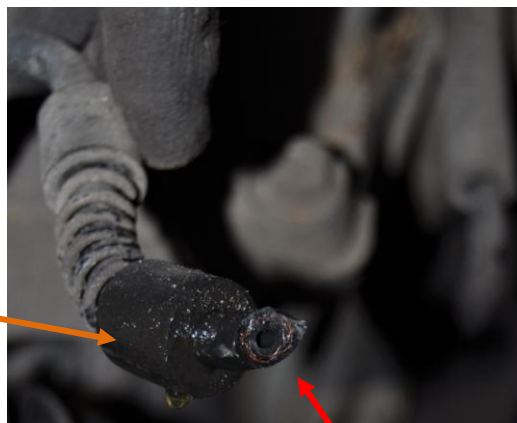
Fot. A.6. Rozdzielony przewód hamulcowy przedniego prawego koła
