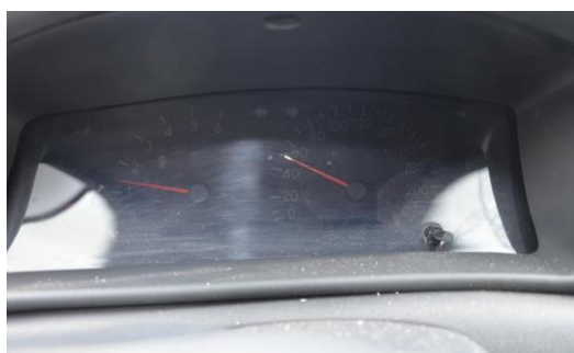
Rys. 4.16. Zatrzymanie wskazówek obrotomierza i prędkościomierza samochodu Toyota
