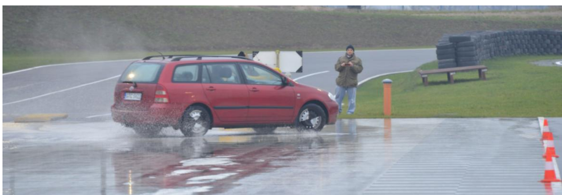
Rys. D.9. Widok samochodu na płycie poślizgowej po obrocie osi tylnej o kąt powyżej 120^\circ
