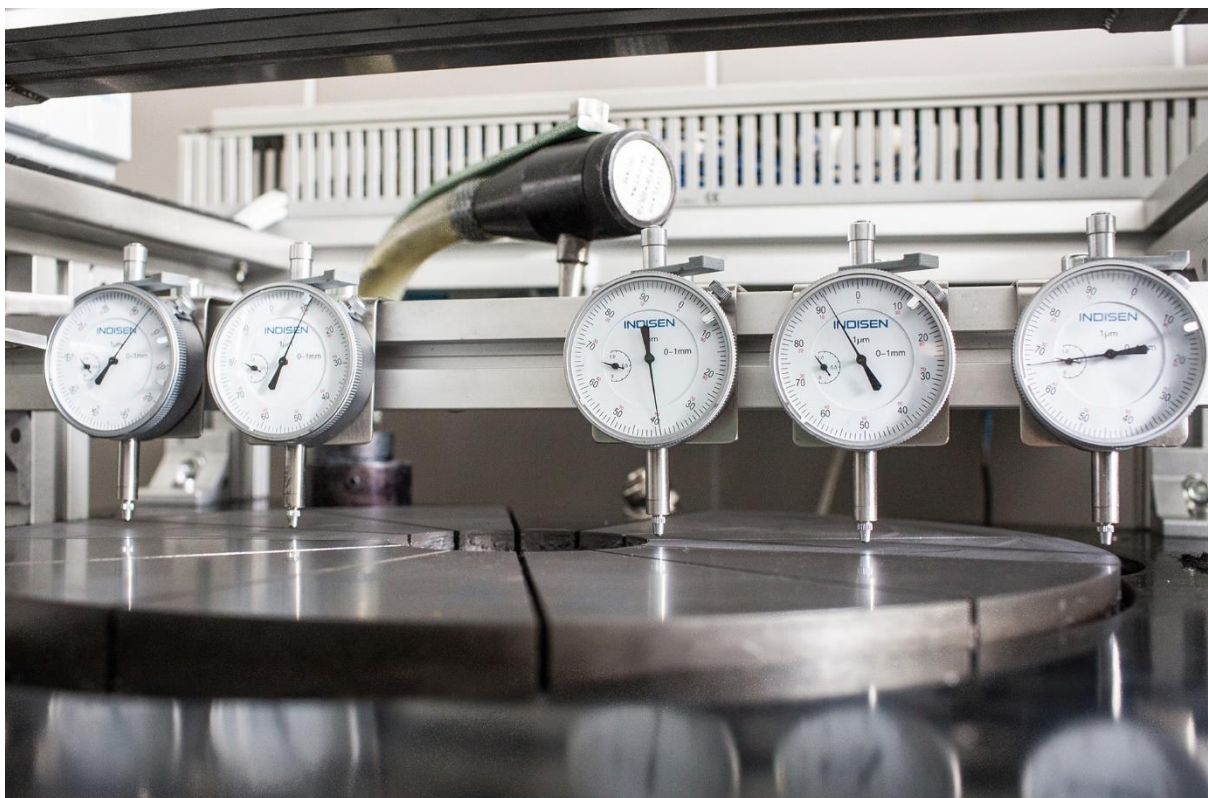
Rys. 8.6. Przyrząd do pomiaru zużycia tarczy docierającej
