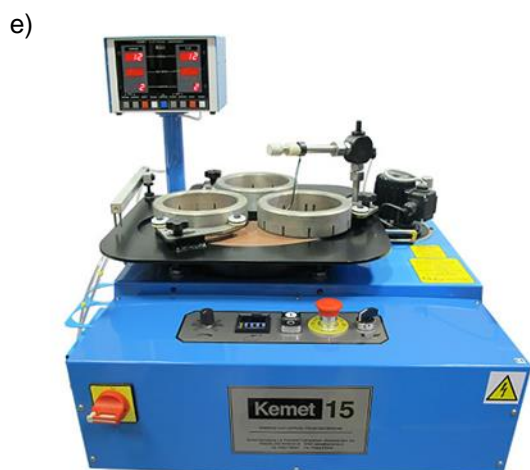
Rys. 2.10. Przykłady aktualnie produkowanych docierarek jednotarczowych: a) Lapmaster Wolters 3R-1200 [87], b) 56 OF Lapmaster Wolters [88], c) Stähli FLM-750 24 PL [89], d) Engis FL-28V [90], e) Kemet 15 [91], f) LamPlan M.M.8400 [92]
